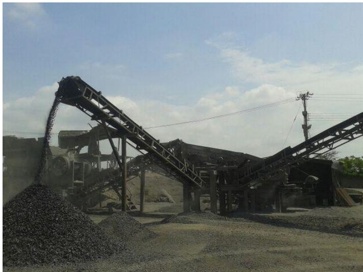
**Ilustración 8:** Clasificadora arena y piedras en proceso
