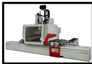
Figura 26. Máquina utilizada para perforar los tableros y poder unir los tableros para formar los módulos.
