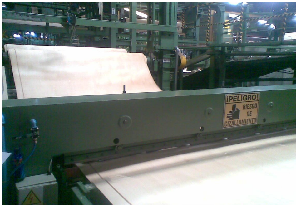
Figura 13. Realiza cortes específicos a las láminas después del desenrollo
