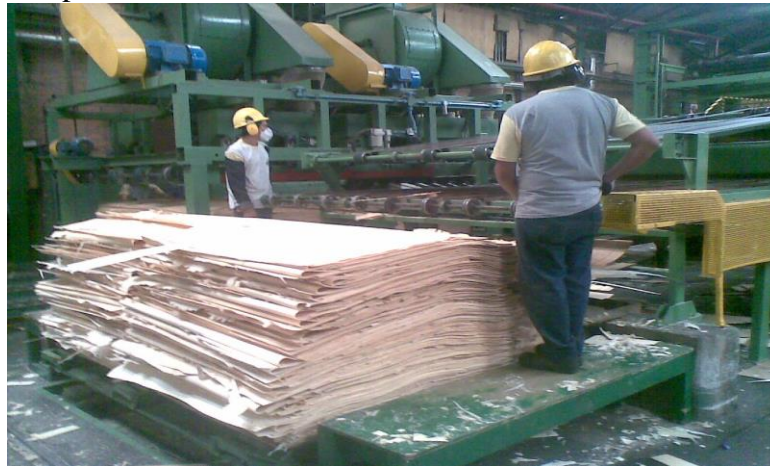
Figura 14. Apilado de Chapas después de ser cortadas
