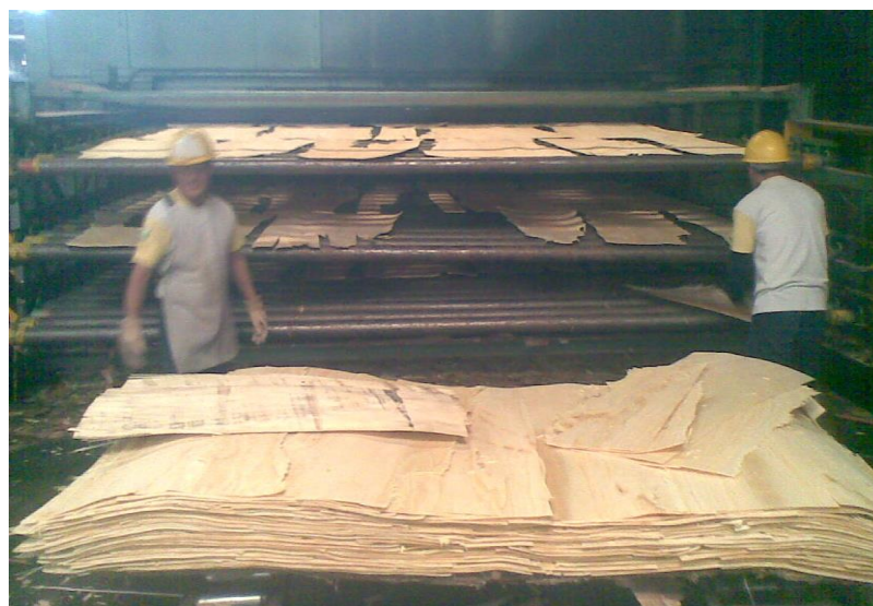
Figura 15. Secado a vapor de chapas
