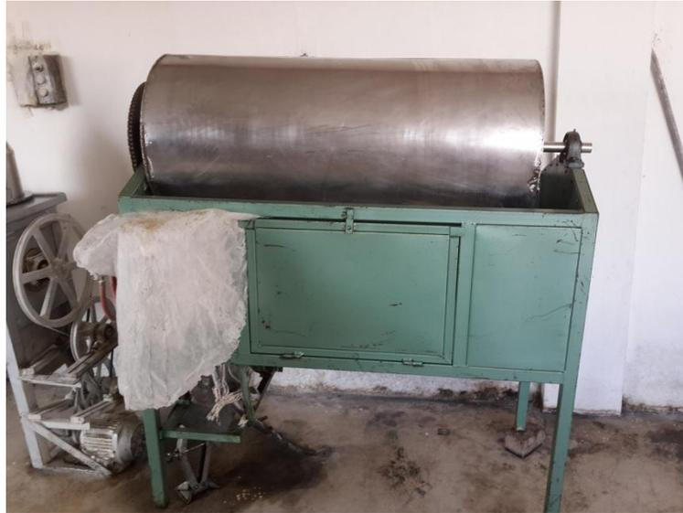
Figura 18. Granulado y secado
