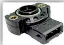
Este sensor de Posición detecta el movimiento de la aleta de aceleración a través de los cambios de voltaje, estos cambios de voltaje llegan a la computadora (ECU) que junto con otros datos calcula la cantidad correcta de combustible que será inyectada al motor. El TPS contiene una resistencia variable con una salida de voltaje de 0 a 0.9 Voltios con la aleta cerrada y cerca de 5 Voltios con la aleta abierta.
