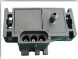
Obtiene información sobre los cambios en la presión atmosférica y el vacío que se produce en el múltiple de admisión, envía una señal a la computadora (ECU) para que pueda controlar el tiempo de ignición o encendido y ajustar la mezcla de aire/combustible en las diferentes condiciones de carga del motor y altitud sobre el nivel del mar.
