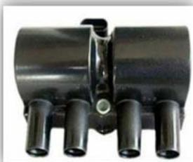
Es un componente esencial del sistema de encendido. Aporta la alta tensión y la energía necesarias para generar la chispa de alta tensión en la bujía de encendido. Las bobinas de ignición, con o sin módulo electrónico emplean una técnica asistida por la computadora (ECU). El óptimo funcionamiento de las bobinas es indispensable para una buena combustión y un buen rendimiento del motor.
