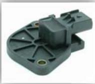
Este sensor inductivo o de efecto Hall, le indica a la computadora (ECU) la posición del árbol de levas para determinar la sincronización de la chispa y la secuencia de inyección.
