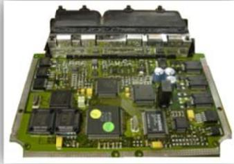
La unidad de control de motor determina la cantidad de combustible, el punto de ignición y otros parámetros monitorizando el motor a través de sensores. Estos incluyen: sensor MAP, sensor de posición del acelerador, sensor de temperatura del aire, sensor de oxígeno entre otros, haciendo que actúen otros dispositivos a la salida de la ECU llamados actuadores, como por ejemplo las bobinas de encendido, inyectores, relés y muchos otros más.
