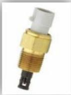
Mide la temperatura del aire que ingresa por el múltiple de admisión, provocando una caída de voltaje en la computadora (ECU) para ajustar la mezcla de aire/combustible y la duración del pulso del inyector.
