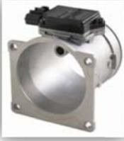
Es un detector de flujo de aire, electrónicamente mide la cantidad de aire que ingresa al motor, por medio de una rejilla o alambres de hilo caliente. La computadora (ECU) usa la información para controlar el combustible y el reglaje del encendido.
