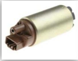
Es un pequeño motor de alta velocidad que acciona un rotor de engranes o impulsor. Bombea a los inyectores de combustible a una presión constante, la computadora (ECU) activa al relé de la electrobomba cuando el switch se encuentra en la posición de encendido.
