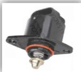
Esta válvula controlada por la computadora (ECU) regula la cantidad de aire desviándola por un lado de la aleta de aceleración. Entra más aire en marcha alta; y menos aire en marcha mínima, logrando así una velocidad de marcha mínima estable.
