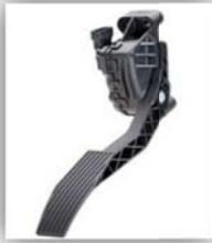
Es un pedal, que contiene dos potenciómetros que pueden ser resistivos o de tipo Hall, que detecta la posición del pedal del acelerador a través de los cambios de voltaje que envía a la ECU para que la aleta del Acelerador Electrónico se abra o se cierre.
