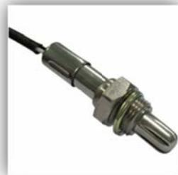
Mide la temperatura del refrigerante del motor a través de una resistencia que provoca la caída de voltaje de la computadora (ECU) para que ajuste la mezcla aire/combustible y el tiempo de encendido. La resistencia es variable, por ejemplo si disminuye la resistencia por efecto de estar sometido a una alta temperatura entonces se dice que la resistencia es un termistor tipo NTC.
