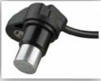
Son detectores inductivos o de efecto Hall, que proveen una señal a la ECU (Electronic Control Unit) para medir las RPM y determinar el encendido e inyección electrónica.
