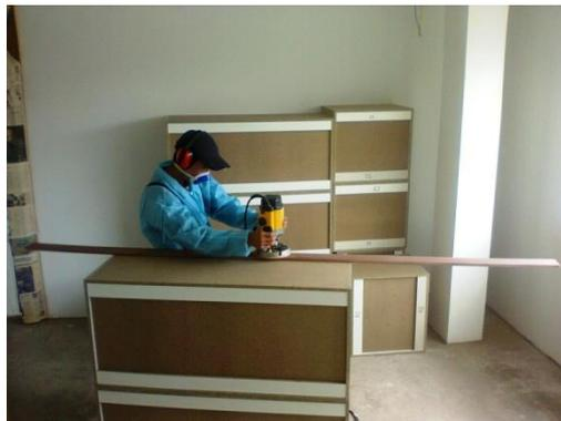
Figura 84 Ruteado con máquina tupí
