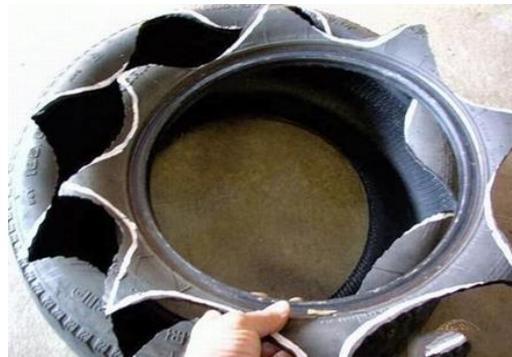
FIG. 29: Separación de las partes cortadas de la llanta
