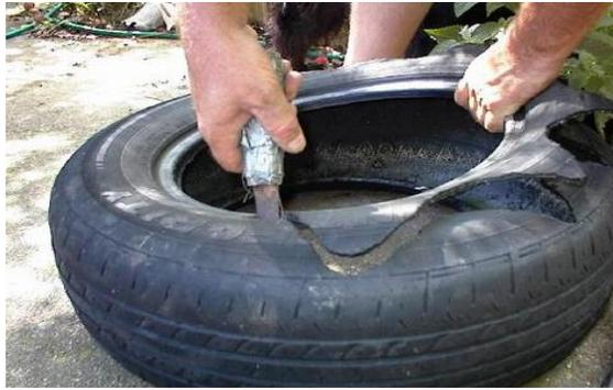
FIG. 28 Corte de la llanta
