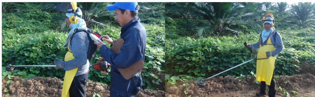
FOTOGRAFÍA N° 1 MEDICIONES DE DOSIMETRÍA DE RUIDO INDUSTRIAL EN PLANTACIÓN
