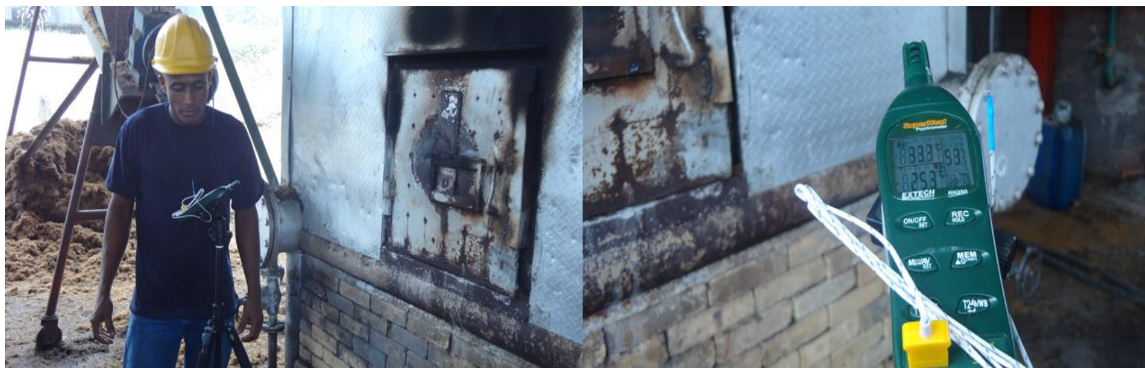
FOTOGRAFÍA N° 6 MEDICIONES DE TEMPERATURA AMBIENTE LABORAL (ÍNDICE WBGT), ÁREA DE CALDEROS
