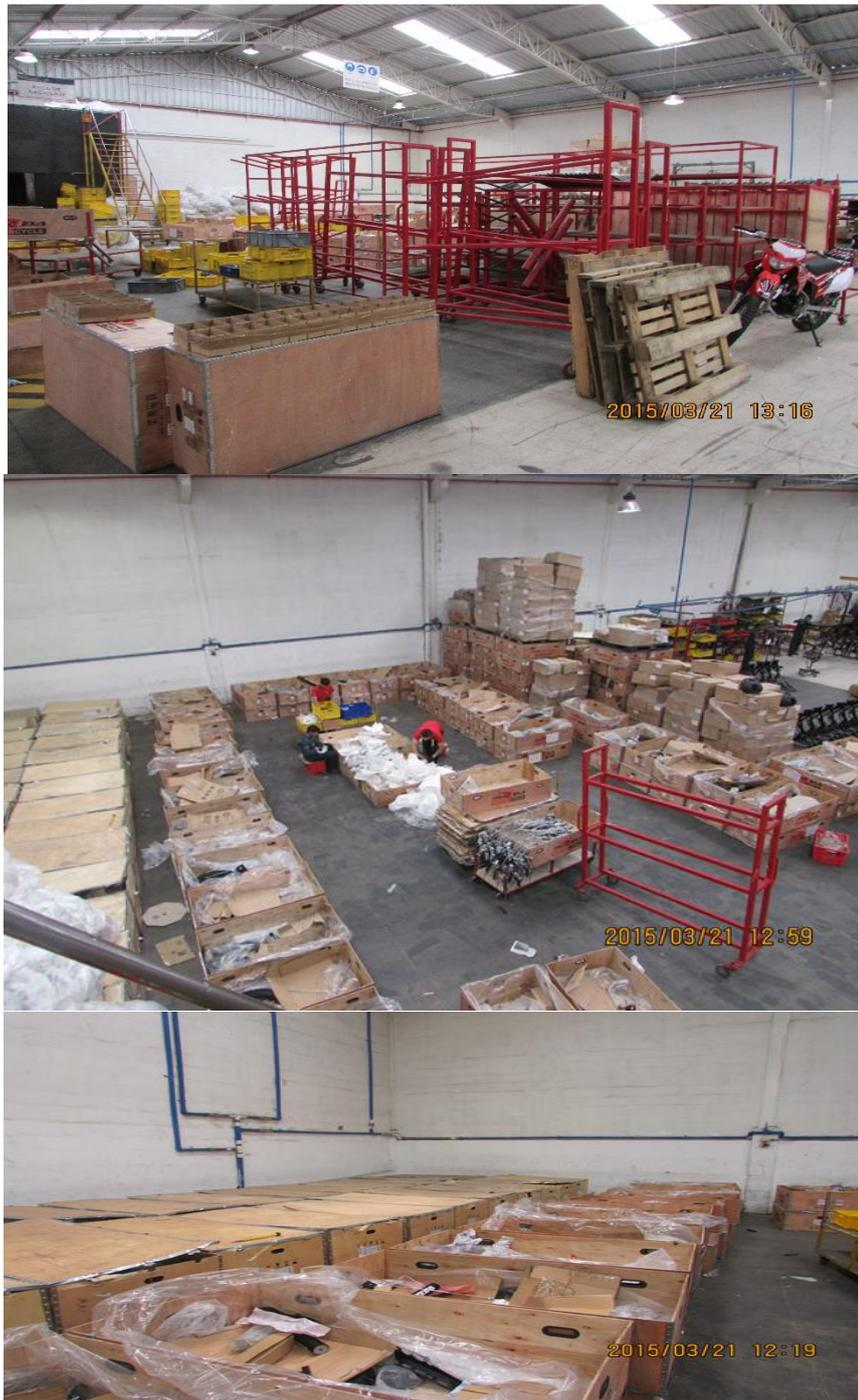
Nota: No existe un proceso determinado y seguro para el desempaque de las piezas por lo que el espacio de trabajo se reduce e impide que se use maquinaria de apoyo para el levantamiento de cajas ya que se los espacios son reducidos o se encuentran obstaculizados por materiales del área.
