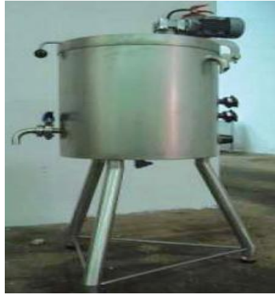
Figura 27. Equipo multiproceso de yogurt Fuente: Inventagri
