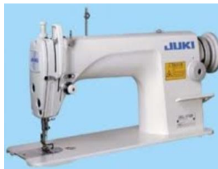
Figura 15. Máquina pespunte. Google, por V. Hidalgo & X. Rocha
