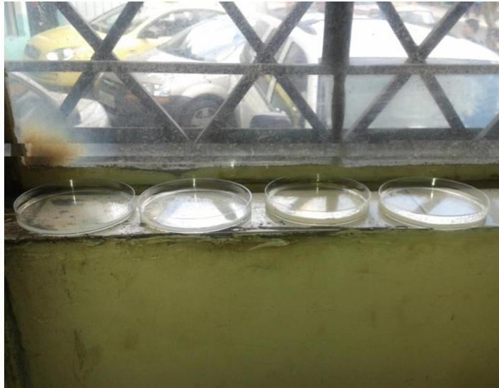
Figura 8. Muestreo de ambientes mediante el método de sedimentación en caja, a) Zona Puerta b) Zona Central c) Zona Horno. Quito –Pichincha 2015.
