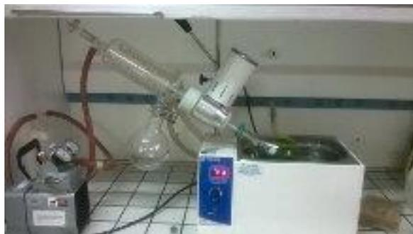
Fig.6 Evaporación en el rotavapor
