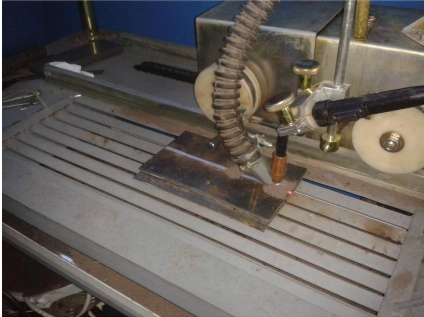
**Proceso de soldadura por arco sumergido**
