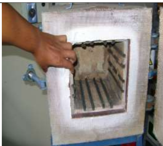
Horno tratamiento térmico
