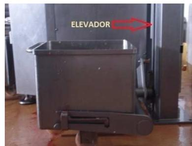
Fig. 2.5 Elevador alimentador del molino.
