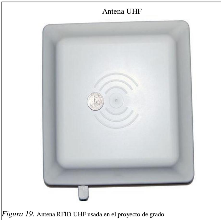
El lector integra con la antena, enciende un led indicador de funcionamiento, cuando detecta una etiqueta el lector, existe un zumbido que indica que está enviando datos, si no existe ninguna etiqueta en el área de cobertura este no envía señales.
