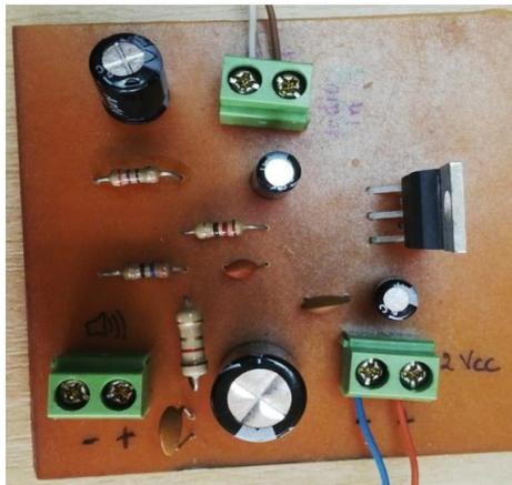
*Figura 29.* Parte posterior de amplificador de audio
