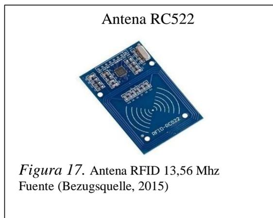
Este módulo utiliza el chip Phillips MF RC522 a 13.56Mhz el cual permite leer los chips de las tarjetas de proximidad usando la interfaz SPI a 3.3V.
