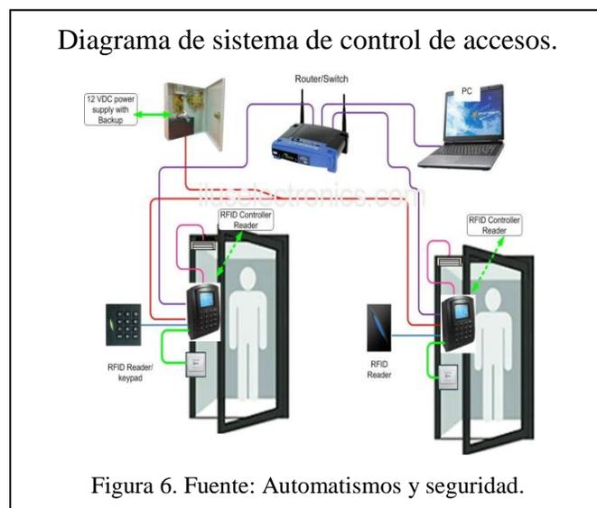
El sistema de control de accesos tiene paneles de control que interactúan con los siguientes dispositivos.
