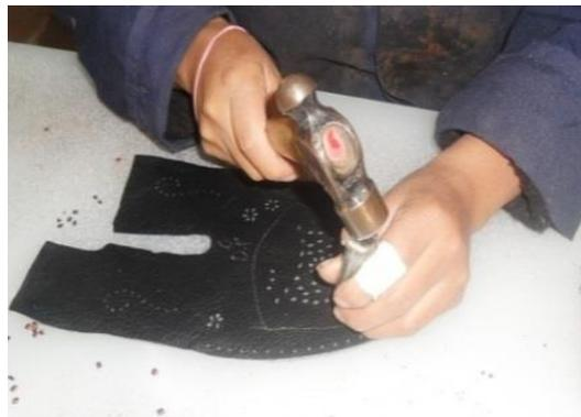
Figura 7. Grabado y perforado del calzado de acuerdo al diseño.
