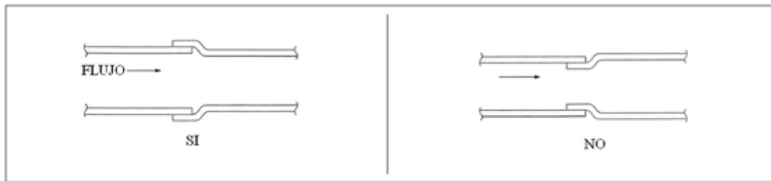
**Figura 4.3** Recomendaciones para la construcción de uniones.
