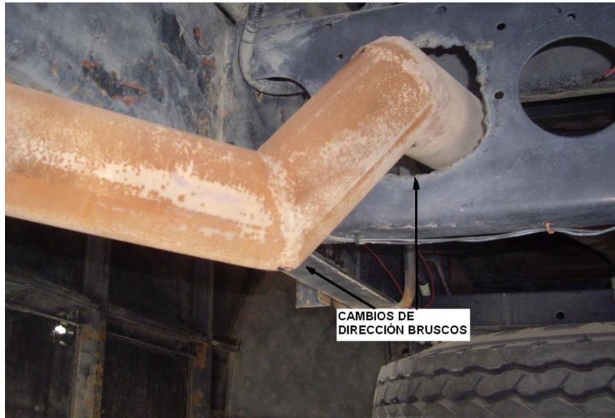
**Figura 1.19** Contrapresión generada por cambios de dirección bruscos
