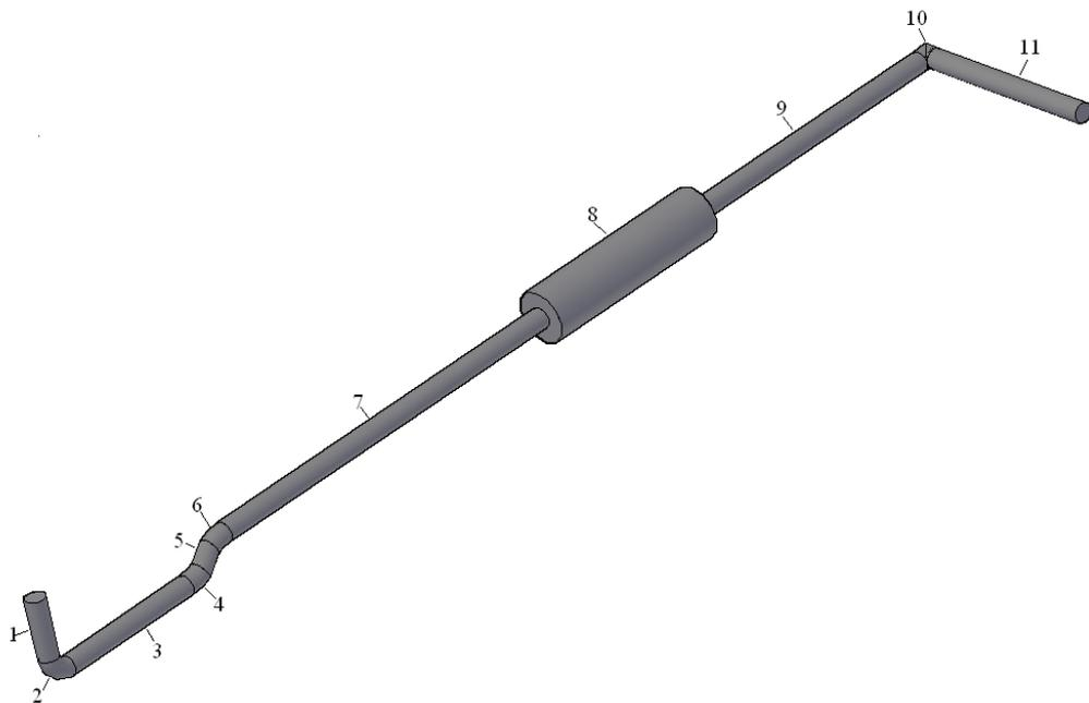
**Figura 3.40** Elementos del sistema de escape con salida en la parte lateral izquierda con codos mitrados después del silenciador del bus con chasis Mercedes-Benz OF1721
