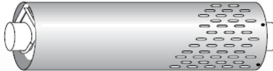
**Figura 1.11** Protección contra el calor colocada en un silenciador
