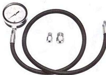
**Figura 1.23** Medidor de contrapresión
