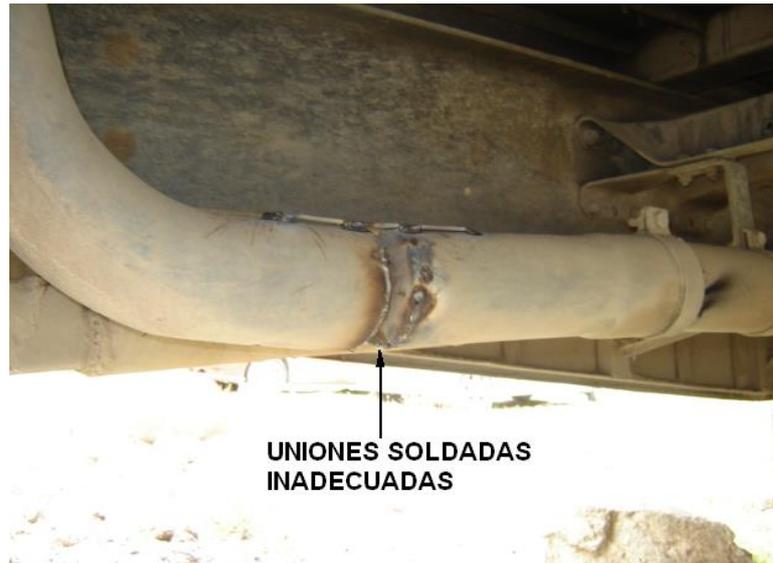
**Figura 1.21** Contrapresión generada por uniones soldadas inadecuadas
