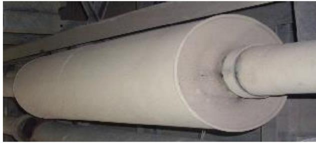
**Figura 1.6** Silenciador del chasis para bus Mercedes-Benz OF1721
