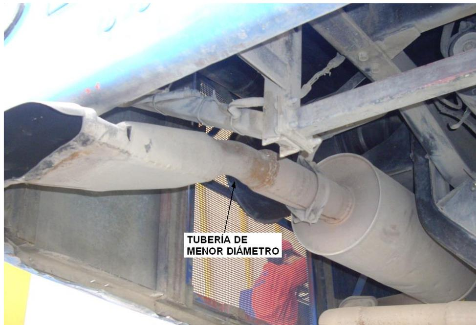
**Figura 1.18** Contrapresión generada por tubería de menor diámetro
