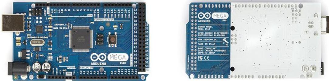
Ilustración 25. Arduino Mega 2560. [12]
