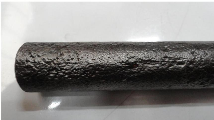
**Figura 4.29** Superficie externa de tubería de conducción de vapor. [22]
