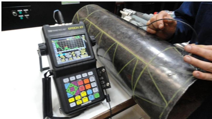
**Figura 3.30** Medición de espesor. [22]
