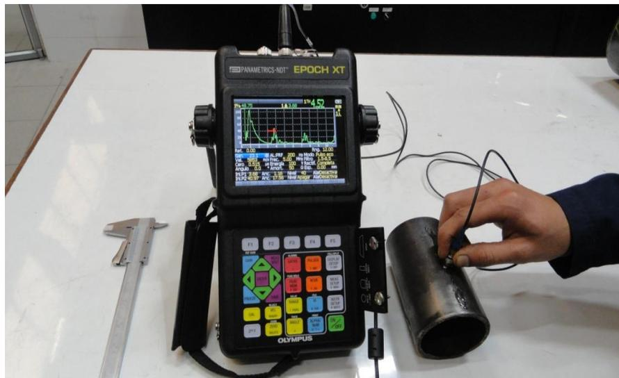
Figura 3.27 Medición de espesores en tubería de prueba. [22]
