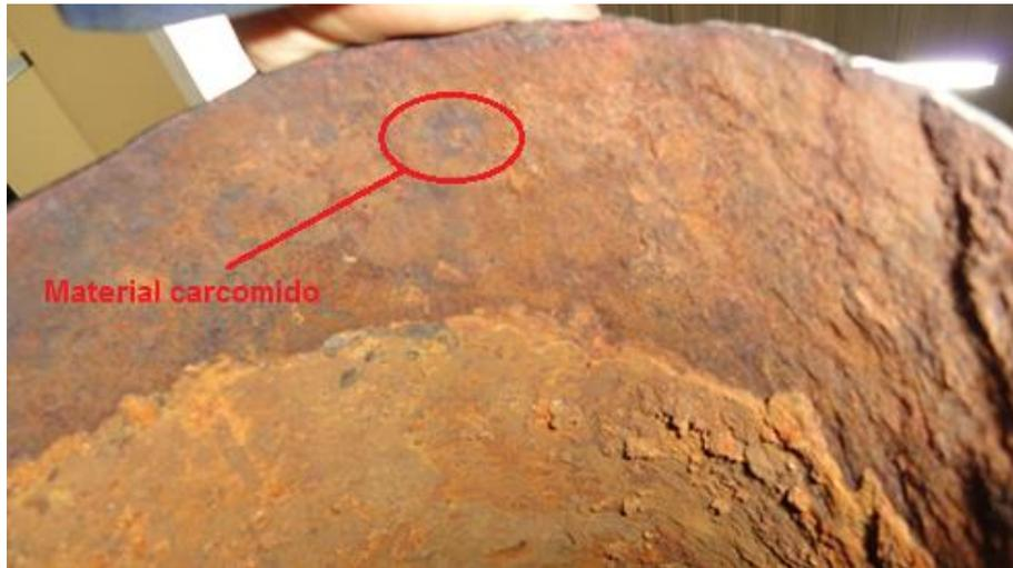
**Figura 4.18** Zona de la discontinuidad interna por desprendimiento de material. [22]
