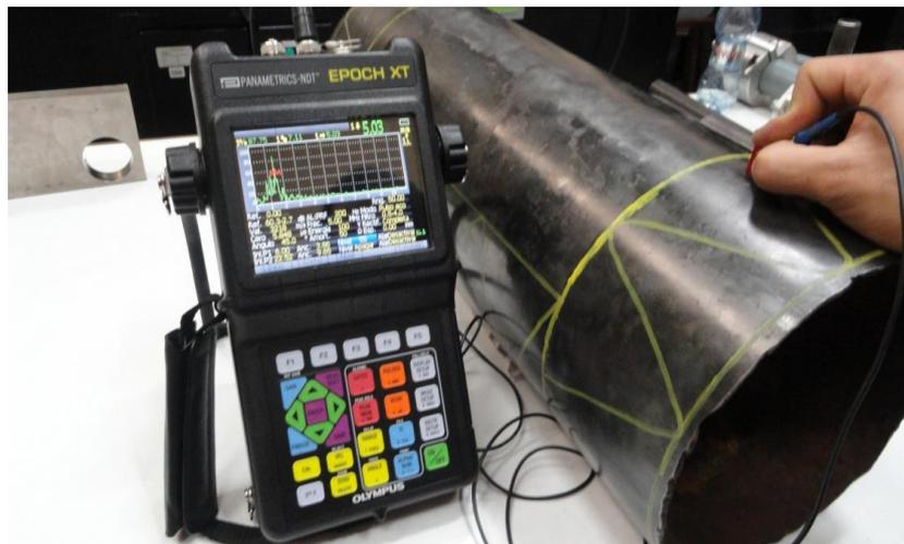
**Figura 3. 41** Examen por haz angular en tubería de prueba. [22]
