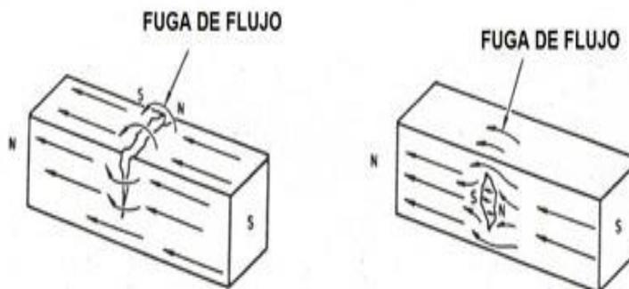
**Figura 1.4** Fuga de campo magnético. [1]
