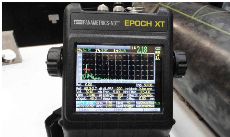
**Figura 4.17** Valor - distancia de discontinuidad interna en la tubería de agua. [22]
