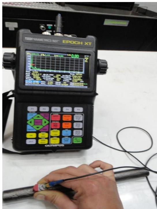
**Figura 4.23** Determinación de discontinuidad superficial en la tubería de vapor. [22]
