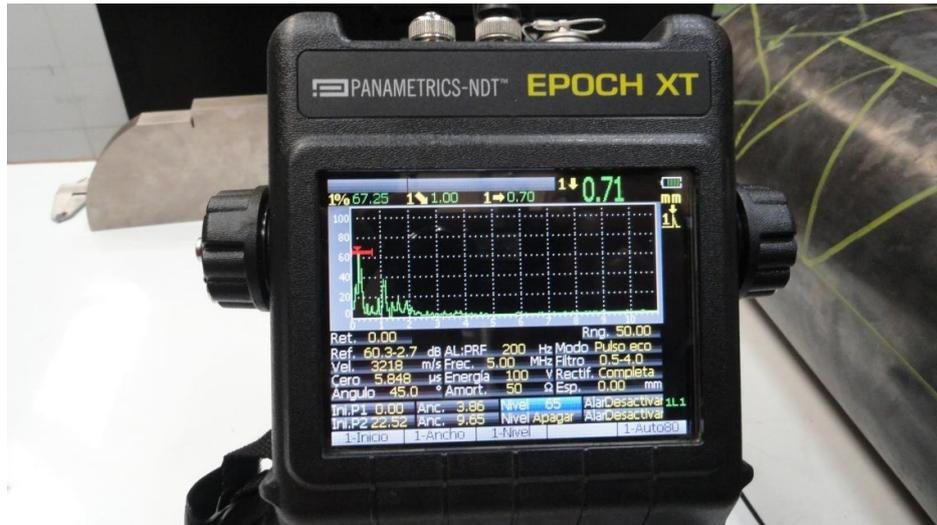
**Figura 4.14** Valor de la distancia de la discontinuidad superficial de la tubería de agua. [22]
