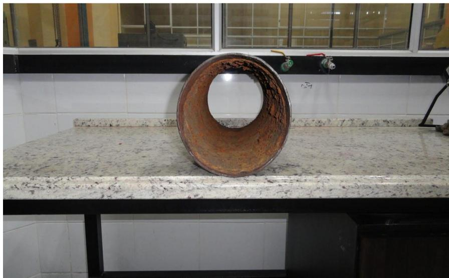
**Figura 4.10** Estado de la tubería de agua seleccionada. [22]
