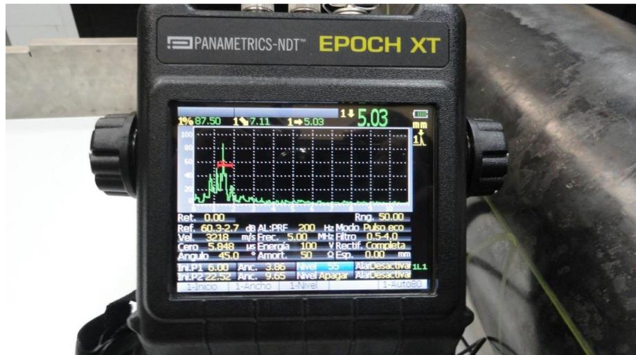
**Figura 3.42** Lectura de imperfección en tubería de prueba. [22]
