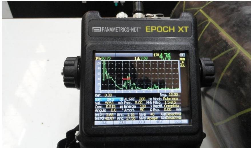
**Figura 3.31** Máximo espesor obtenido en la tubería. [22]
