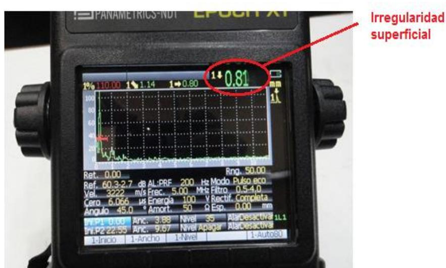
**Figura 4.24** Valor de la distancia de la discontinuidad superficial en la tubería de vapor. [22]
