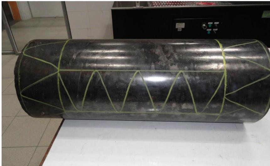
**Figura 3.29** Trazado de trayectoria para realizar el examen. [22]
