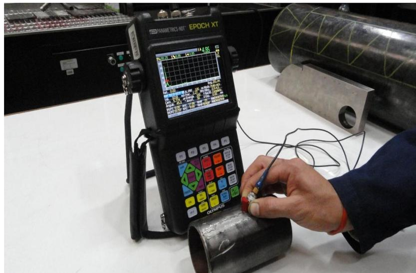
**Figura 3.39** Examen por haz angular en tubería de prueba. [22]
