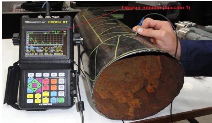
**Figura 4.12** Espesor mínimo de la sección 1, de la tubería de agua. [22]
