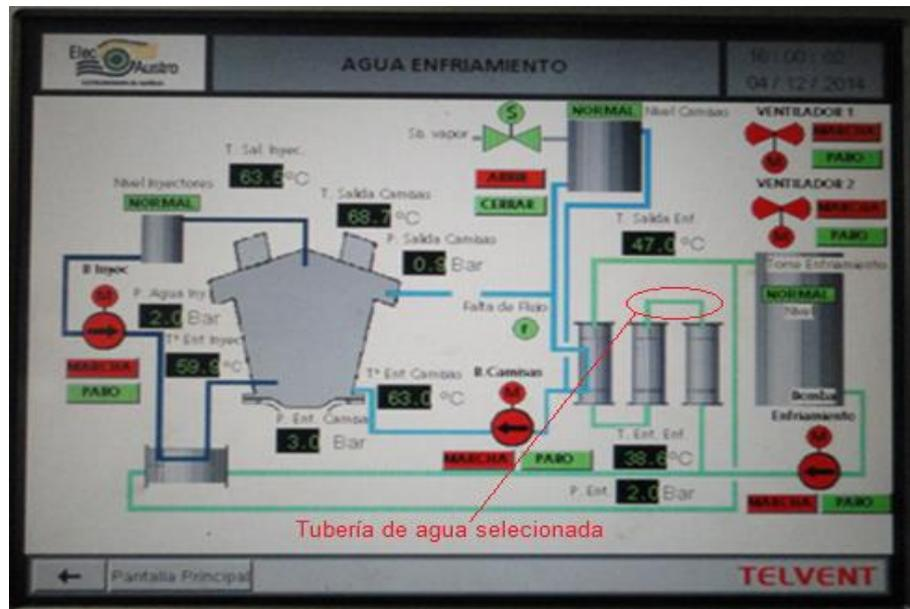
**Figura 4.7** Esquema de ubicación de la tubería de agua seleccionada en la Central Termoeléctrica. [22]
