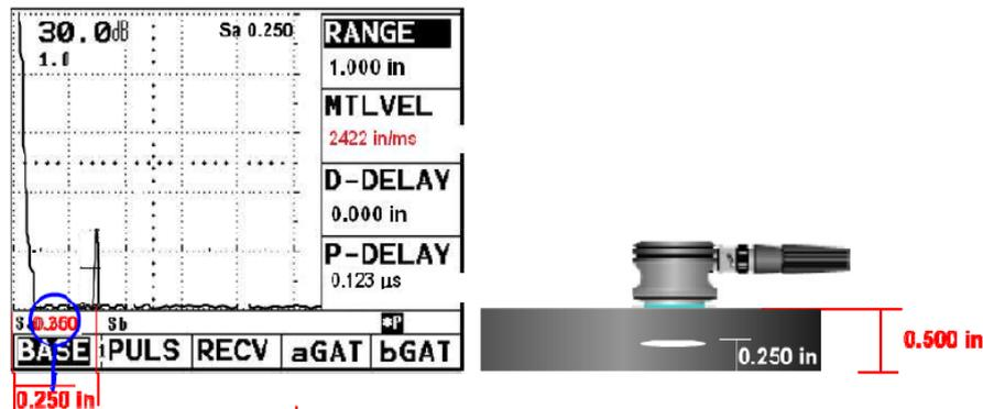
**Figura 2.14** Detección de una discontinuidad con haz recto. [9]
