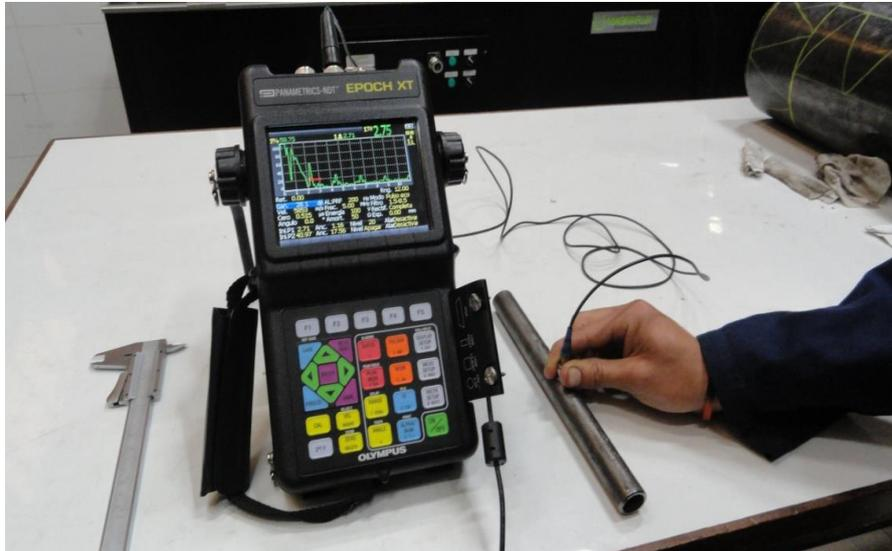
Figura 3.36 Medición de espesor. [22]
