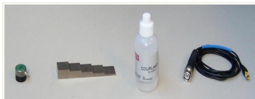
**Figura 2.10** Materiales para calibración con haz recto. [18]
