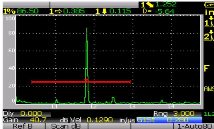
Figura 2.7 Pantalla con barrido A-scan. [18]
