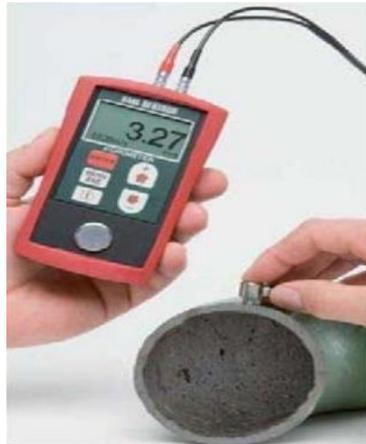
**Figura 2.1** Medidor de espesores. [13]
