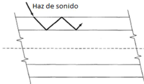
**Figura 3. 6** Propagación axial del sonido en la pared de una tubería. [20]
