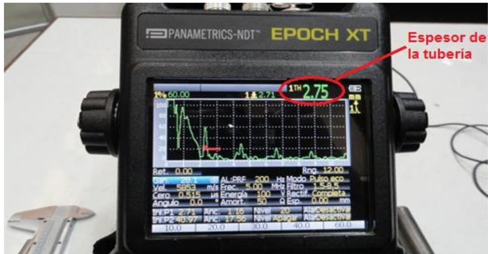
**Figura 4.22** Valor del espesor de la tubería de vapor. [22]
