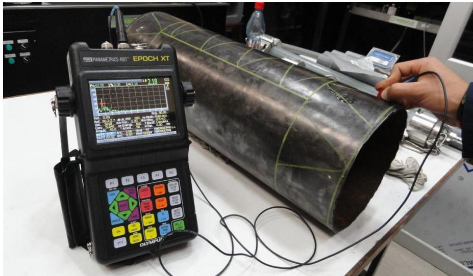
**Figura 4.16** Detección de discontinuidad interna en la tubería de agua. [22]
