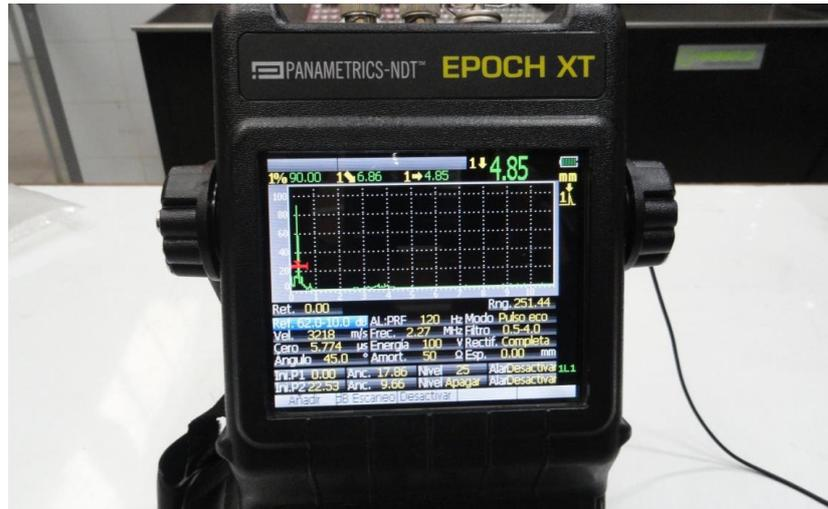
**Figura 3.40** Lectura de imperfección en tubería de prueba. [22]
