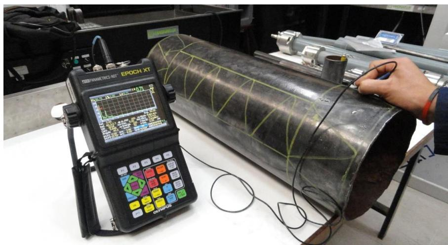
**Figura 4.13** Detección de discontinuidad superficial en la tubería de agua. [22]
