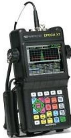
**Figura 2.6** Equipo ultrasónico EPOCH XT. [17]
