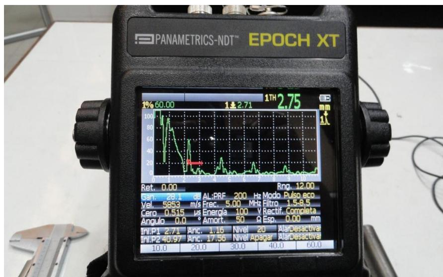
Figura 3.37 Espesor obtenido. [22]
