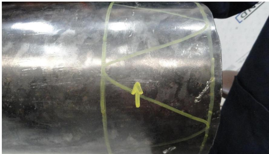
**Figura 4.15** Ralladura superficial de la tubería de agua. [22]
