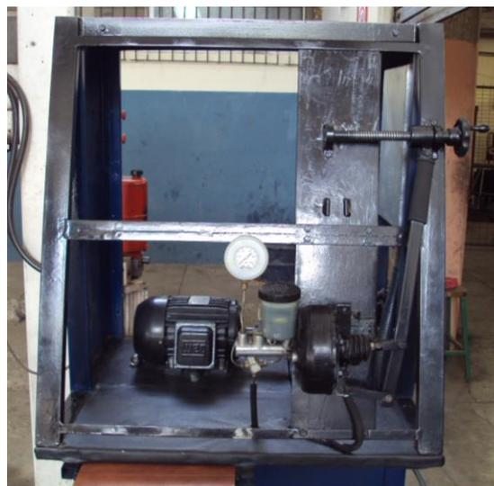
**Grafico 76. Maqueta para realizar el ensayo de durabilidad de discos de freno.**
