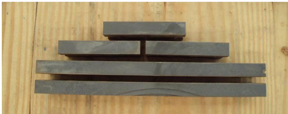
**Grafico 41. Probetas obtenidas del corte por chorro de agua.**
