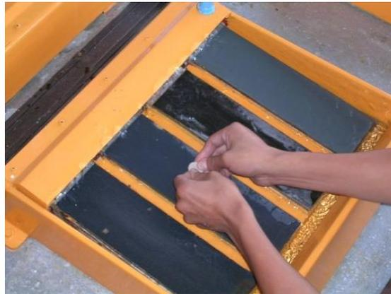
**Grafico 9. Banco de Lijado. Fuente: Laboratorio metalografía U.P.S.**
