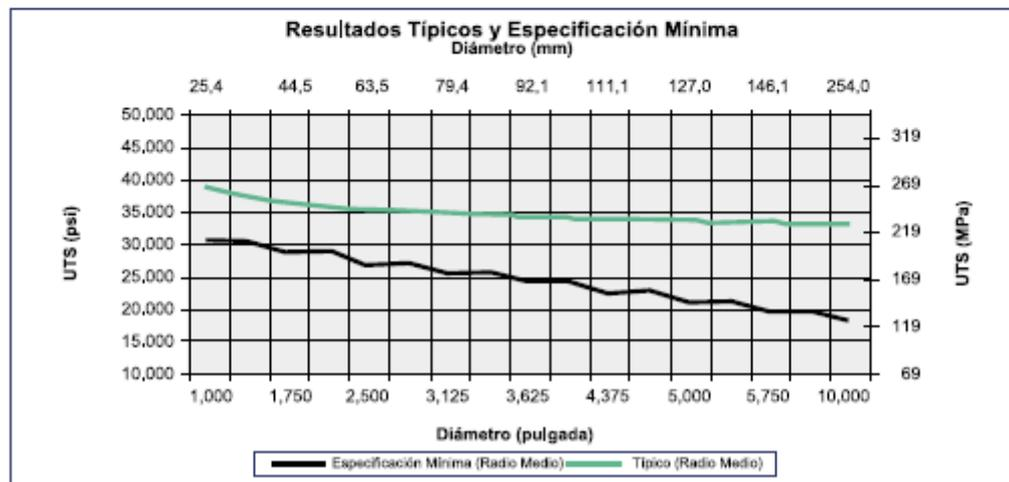
Figura 8 - Límite de resistencia a la tracción de VERSA-BAR FC-200 (resultados típicos y especificaciones mínimas)
