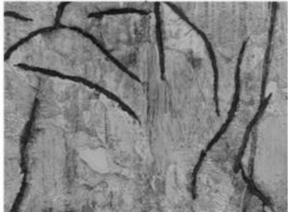
**Grafico 63. Disco Alterno calentado a 350°C y enfriado en agua.**
