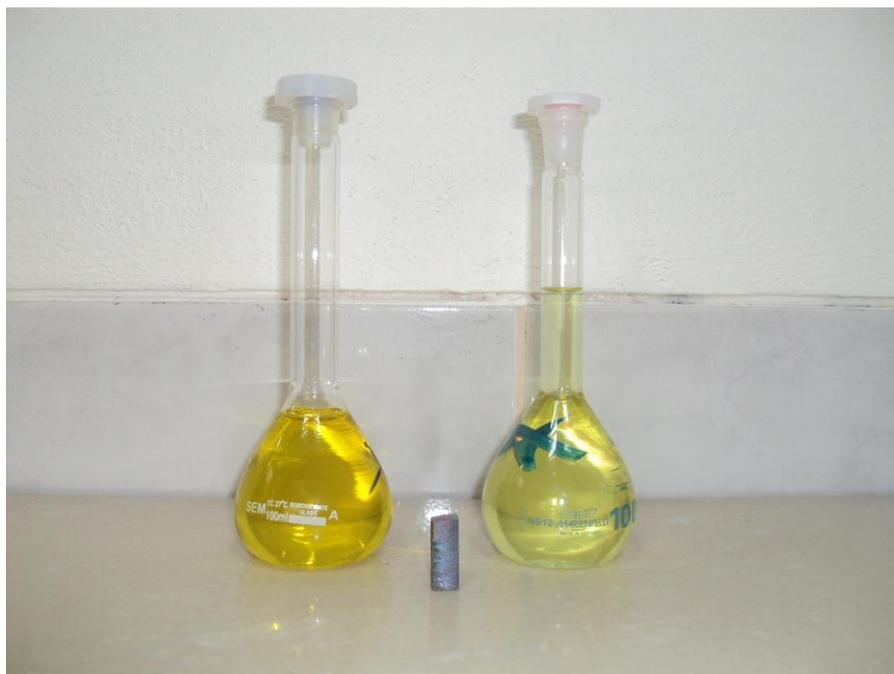
**Grafico 44. Solución A y C listas para colocar en la máquina de absorción atómica. Fuente. Los Autores.**
