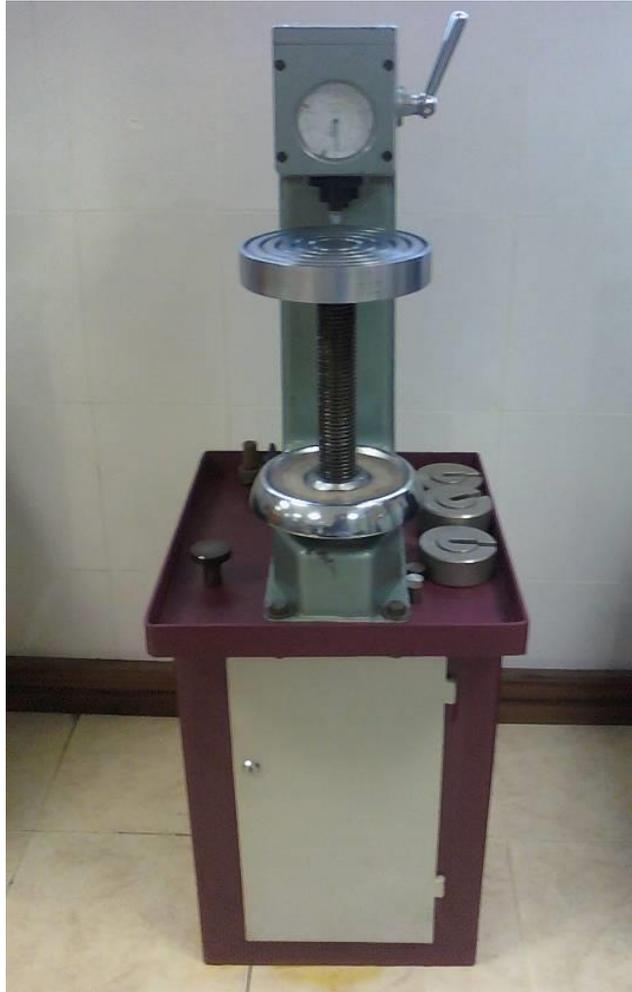
**Grafico 54. Máquina para ensayo de dureza Brinell.**
