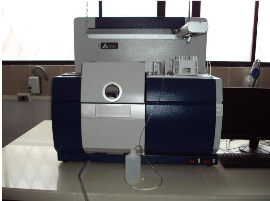
**Grafico 45. Espectrómetro de Absorción Atómica AI 1300. Fuente. Los Autores.**
