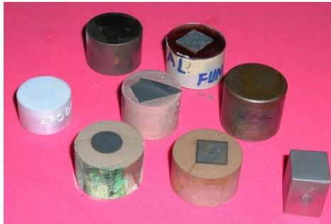
**Grafico 8. Probetas metalográficas. Fuente: Laboratorio de metalografía de la U.P.S.**
