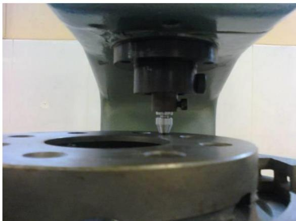
**Grafico 55. Identador 1/16" para ensayo de dureza.**
