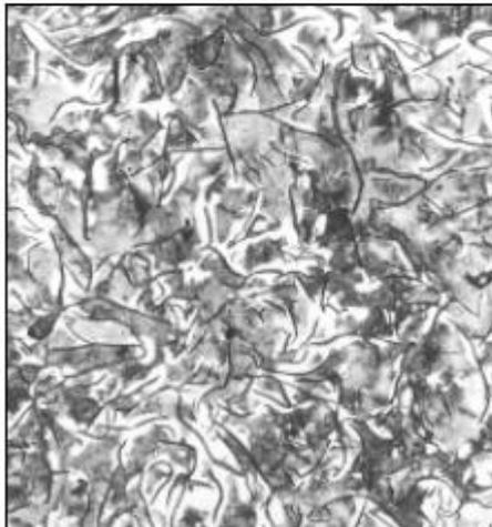
Figura 6 - Microestructura típica en el núcleo (VERSA-BAR FC-200)
