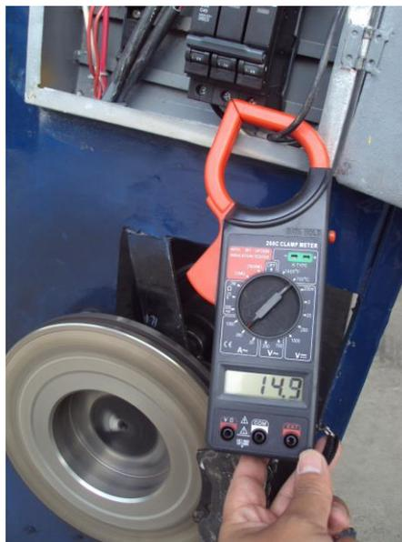
**Grafico 80. Control del motor eléctrico mediante multímetro de gancho.**
