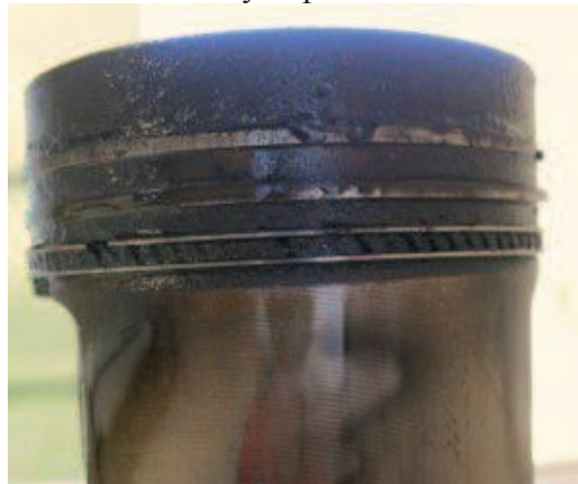
Figura 4. 24 Anillos quemados debido a depósitos de carbón. FUENTE: www.widman.biz/boletines/121.html
