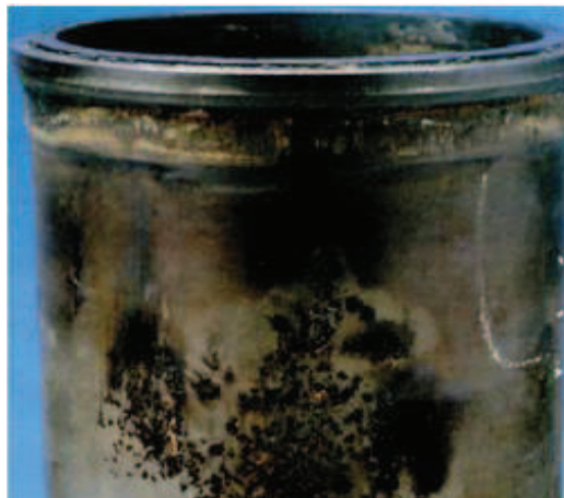
Figura 4. 26 Erosión de la camisa por cavitación. FUENTE: www.itacr.com/boletin-FEL-PRO.html
