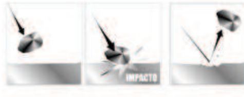
Figura 1. 23 Erosión. FUENTE: machinerylubrication.com
