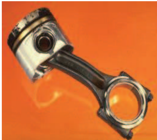
Figura 4. 29 Biela doblada por fuerzas externas.
