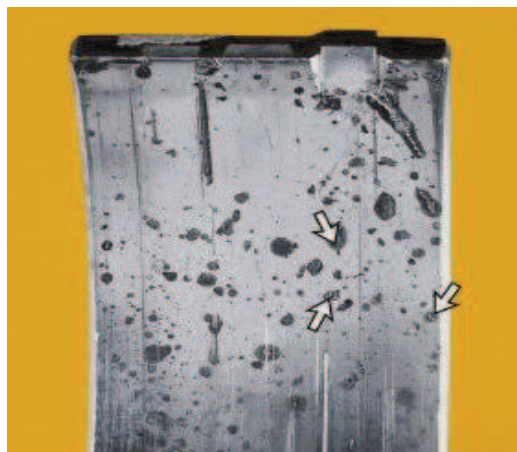
Figura 4. 32 Raspaduras en la superficie del cojinete a causa de elementos incrustados.
