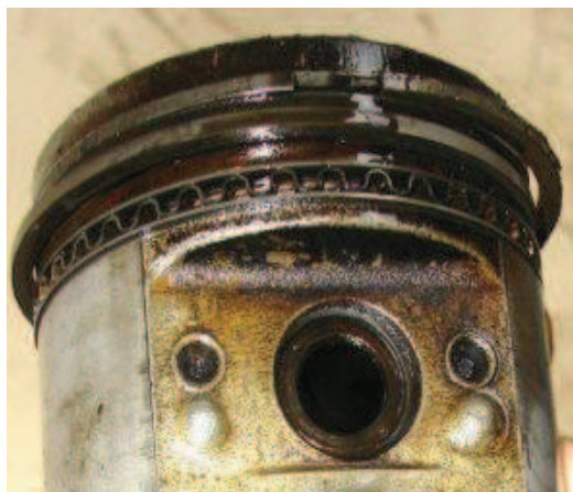
Figura 4. 25 Rotura de anillo en el funcionamiento del motor. FUENTE: www.widman.biz/Seleccion/viscosidad.html
