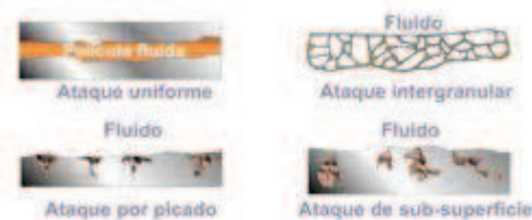
Figura 1. 22 Corrosión. FUENTE: machinerylubrication.com
