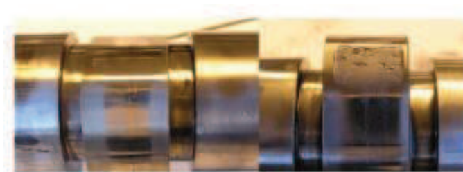
Figura 4. 35 Desgaste del material del árbol de levas a causa del trabajo que realiza.
