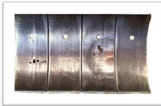
Figura 3. 2 Corrosión sobre cojinete debido a contaminación por agua.
