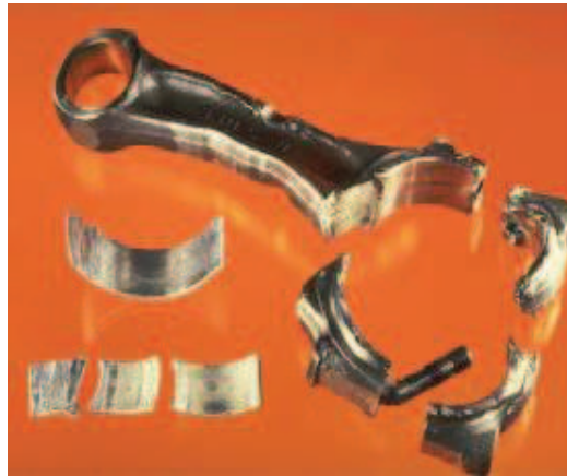
Figura 4. 27 Falla de la biela por su propia fractura.
