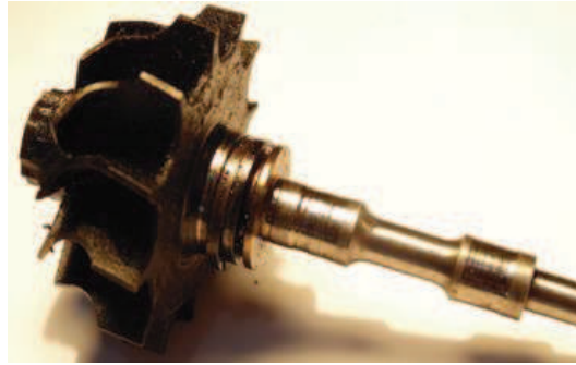
Figura 4. 36 Desgaste turbocompresor por uso en general. FUENTE: turbo-tec.com.mx/interiores/analisis.php
