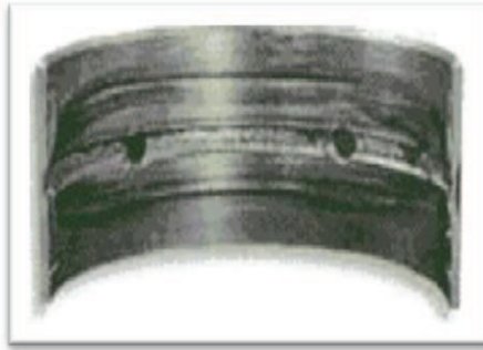
Figura 3. 5 Desgaste de cojinete por falta de viscosidad del aceite. FUENTE: http://www.widman.biz/Analisis/desgaste.html
