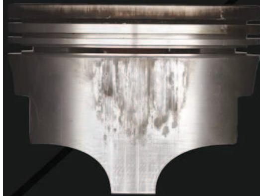
Figura 4. 23 Rayado del pistón por falta de lubricación.
