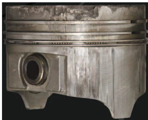
Figura 4. 22 Deformaciones del pistón a causa de las altas temperaturas. FUENTE: www.itacr.com/analisis_averias.html
