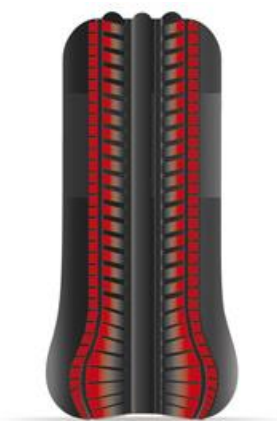
Ilustración 9: Contacto de un neumático con la calzada con baja presión de inflado. Fuente: [3]
