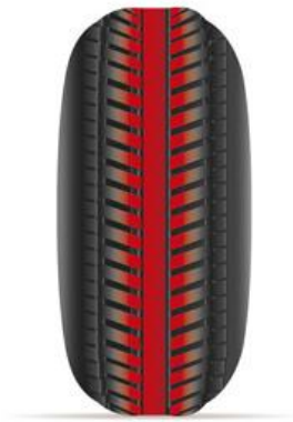
Ilustración 10: Contacto de un neumático con la calzada con sobrepresión de inflado. Fuente: [3]
