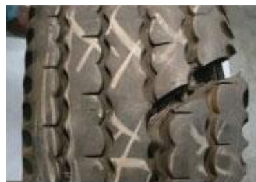
Ilustración 14: Daño del neumático por sobrecarga. Fuente: [3]
