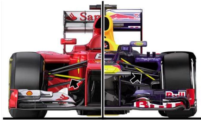
*Figura 1.12 Suspensión Pull Rod (Izquierda), Push Rod (Derecha) [10]*
