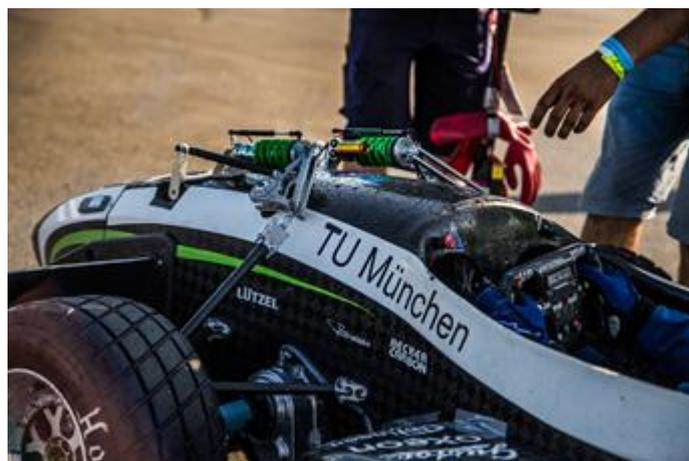
*Figura 1.8 Disposición de amortiguadores Universidad Técnica de Múnich [4]*
