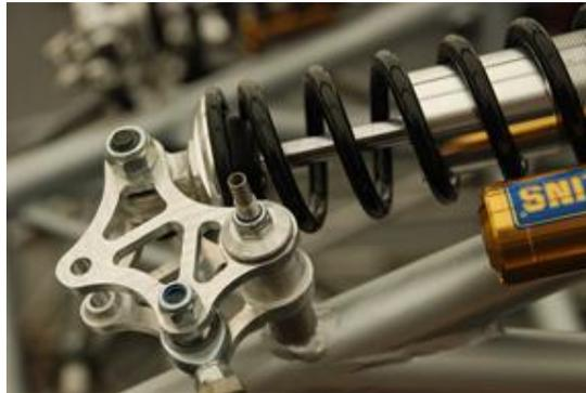
*Figura 1.7 Rocker mecanizado [2]*
