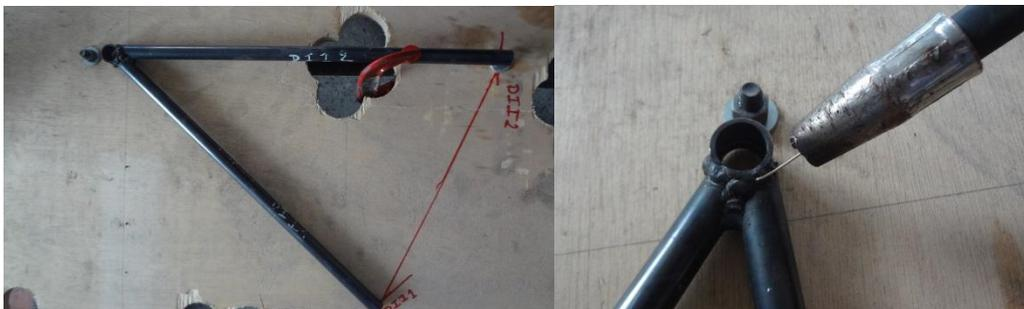
*Figura 3.13* Proceso de soldadura de brazos de suspensión
