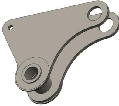
**Figura 3.9** Modelado en CAD del balancin posterior
