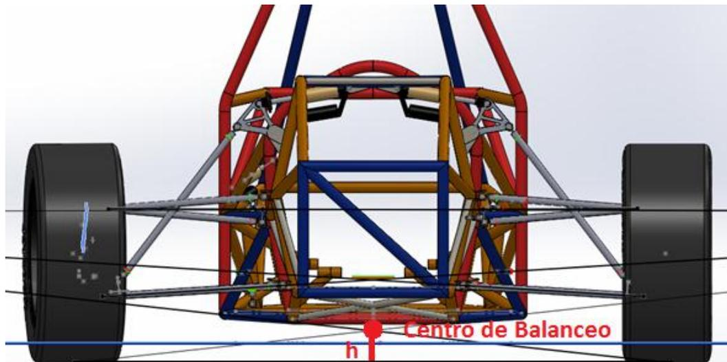
*Figura 2.42 Altura del centro de balanceo en diferentes momentos, con la suspensión delantera en funcionamiento*
