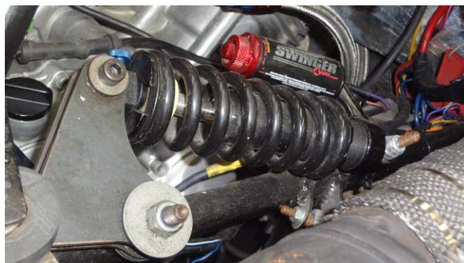
*Figura 3.16 Conjunto balancín –amortiguador ensamblado en el vehículo*
