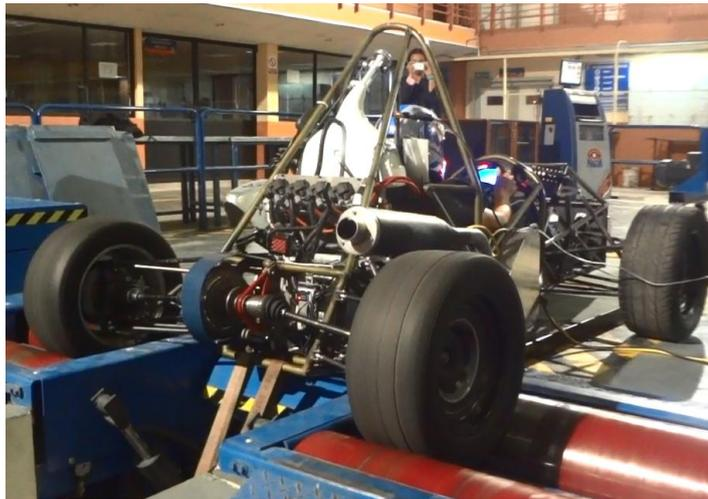
*Figura 4.1 Pruebas para programación del motor*
