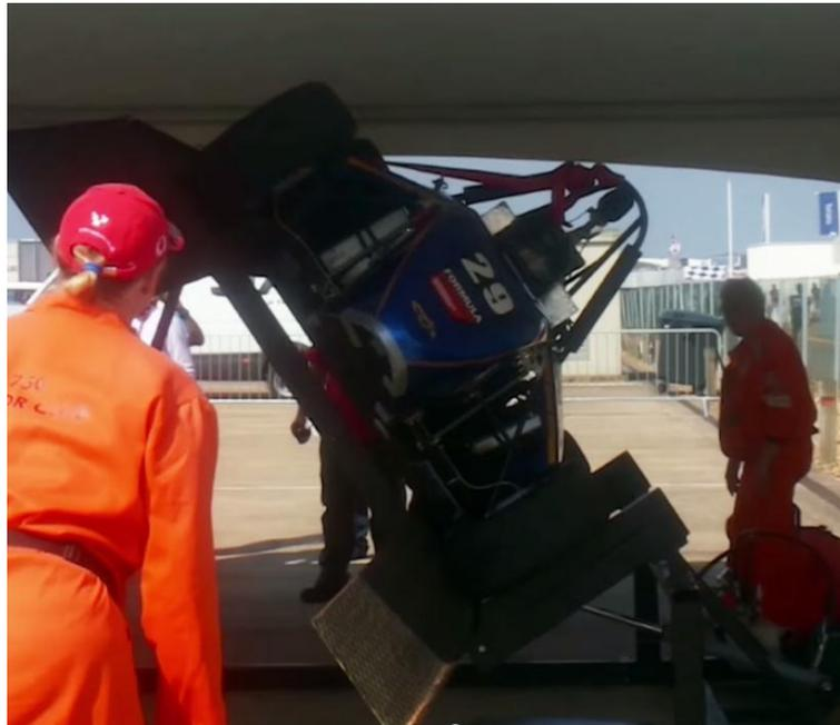
*Figura 4.4 Prueba de inclinación realizada a 60 grados*
