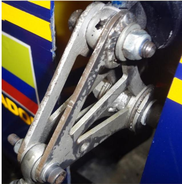
*Figura 3.11 Balancín delantero ensamblado en el vehículo.*
