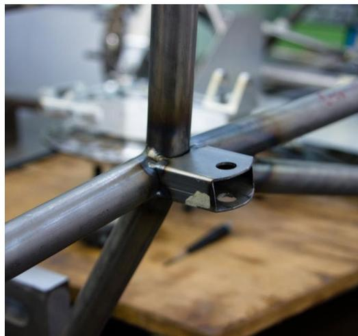
**Figura 4.8** Anclaje de suspensión mediante perfil de acero
