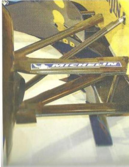
*Figura 1.11 Suspensión de brazos de diferente medida y no paralelos, Renault R25 [9]*
