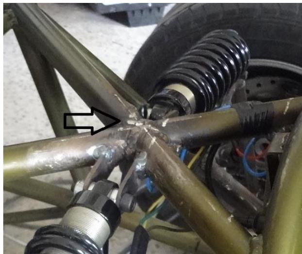
*Figura 3.15 Puntos de referencia para la suspensión realizados en el chasis*
