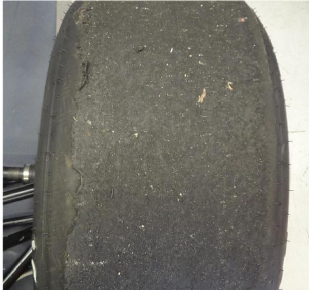
*Figura 4.6 Degradación del neumático posterior izquierdo luego de la competencia*
