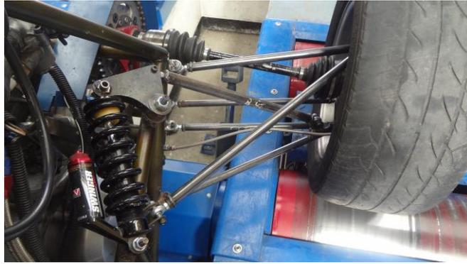
*Figura 3.19* Ensamble final de la suspensión posterior
