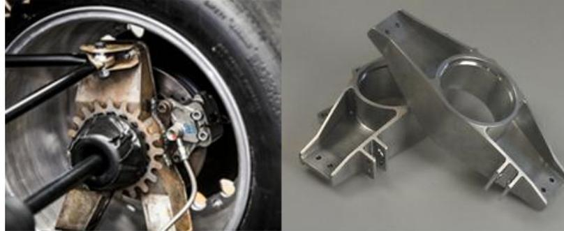
*Figura 1.6 Manguetas de chapa soldada (izq) y mecanizada (der). [4]*
