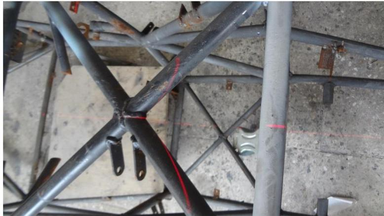
*Figura 3.14 Alineación del chasis con ayuda de láser.*
