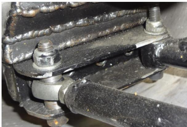
*Figura 3.18 Brazo de convergencia posterior ensamblado con la mangueta.*
