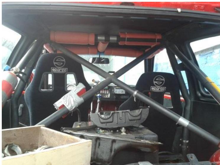
**Figura 1.2.** Roll bar utilizado actualmente
