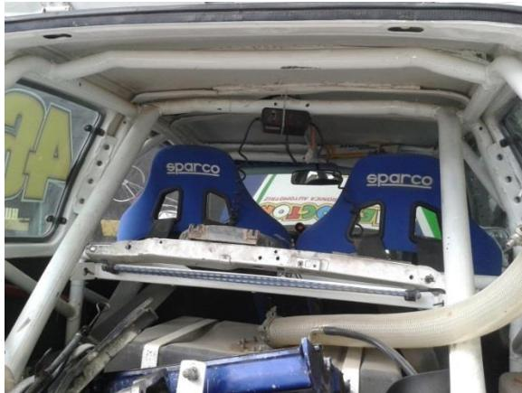
**Figura 3.2.** Roll bar Suzuki Forza 1.
