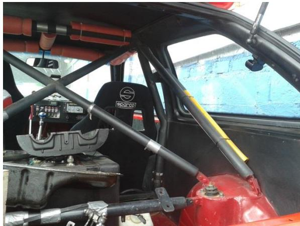
**Figura 1.27.** Arco de seguridad atornillado.
