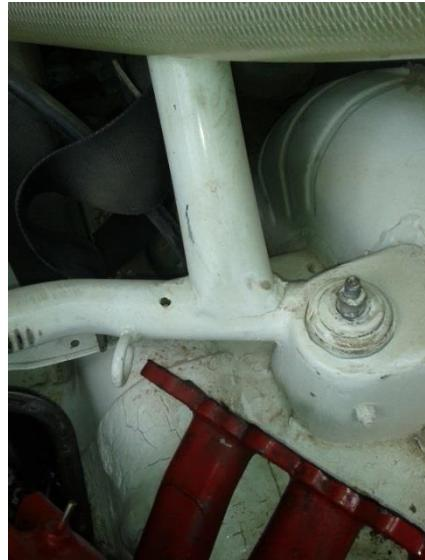
**Figura 1.33.** Montaje soldadura directa a la carrocería.
