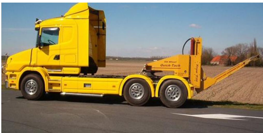
Figura 23 Sistema Under-lift Desmontable 24 .
