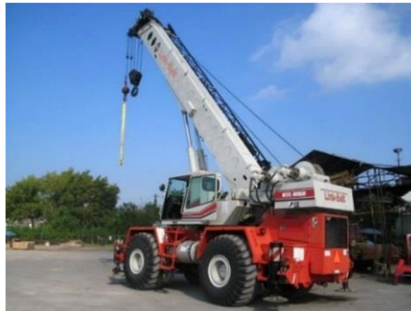
Figura 12 Grúa Automotriz con pluma no orientada. 11
