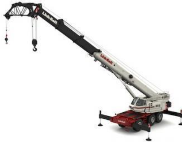
Figura 11 Grúa Automotriz y desplazable con giro parcial. 10
