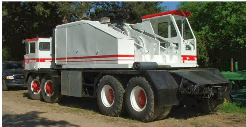
Figura 15 Grúa sobre camión con pluma no orientada. 14
