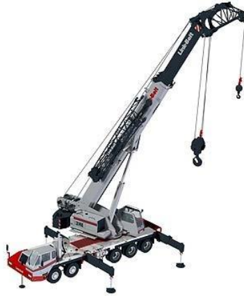
Figura 13 Grúa sobre camión con giro total 12 .
