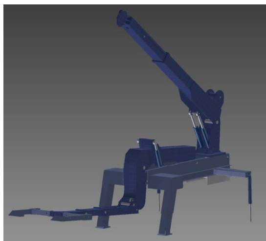
Figura 79 Remolcador Grúa desmontable a la Quinta Rueda 85 .
