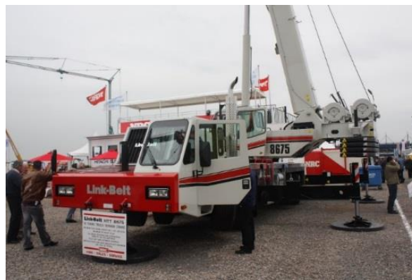
Figura 14 Grúa sobre camión con giro parcial. 13
