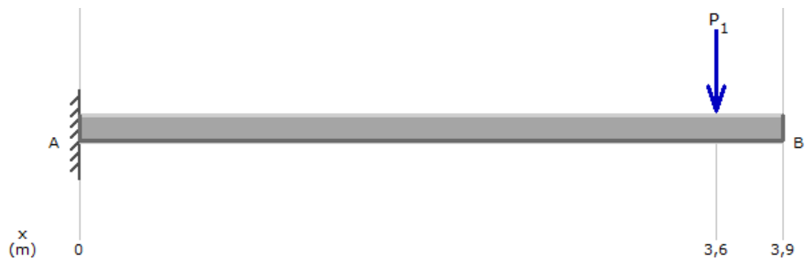
Figura 48 Diagrama Cuerpo Libre Cuchara 20 KN 53
