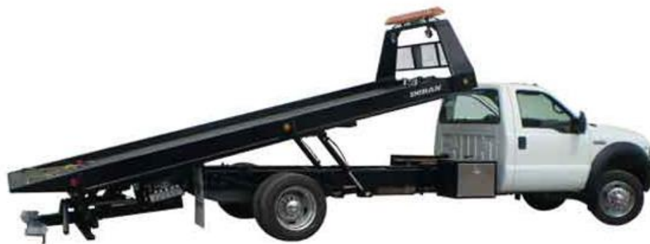
Figura 20 Vehículos remolcadores de superficie plana. 19
