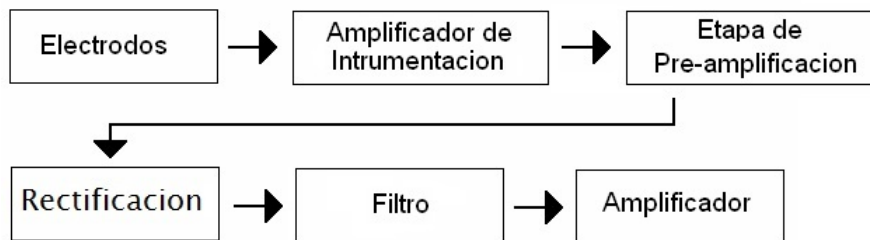
Figura 2.15: Diagrama de bloques de adquisición de señal.
