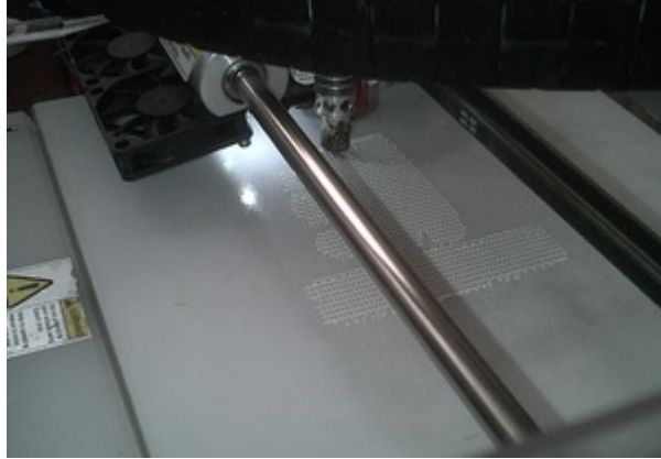
Figura 3.16: Creación de la malla de soporte.
