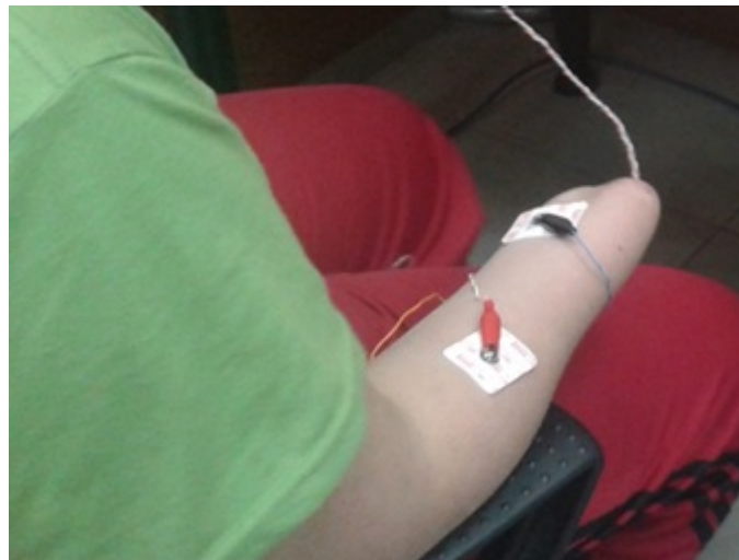
Figura 3.44: Posición de los electrodos para la obtención se la señal.
