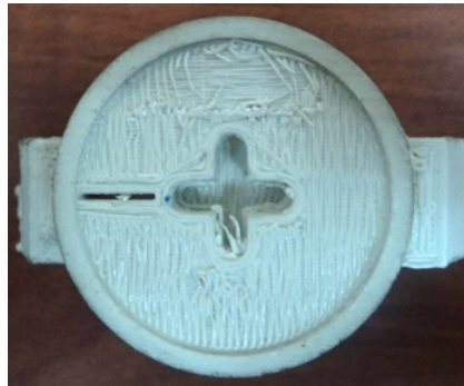
Figura 3.71: Acople giratorio de la muñeca.
