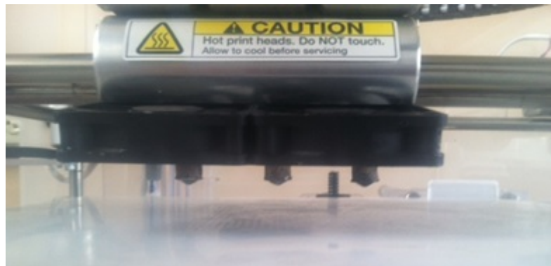
Figura 3.22: Calibración de las boquillas con la mesa de impresión.
