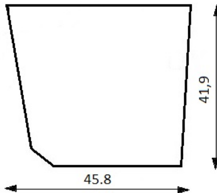
Figura 3.59: Dimensiones de la tarjeta de control.
