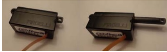
Figura 3.53: Desplazamiento del vástago. [1]
