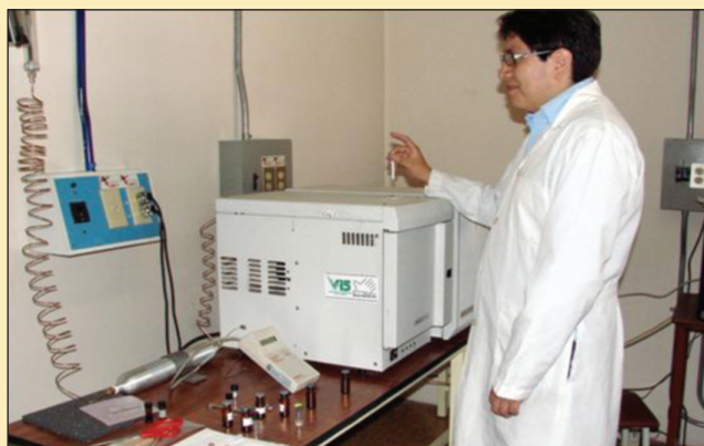
Figura 4. Equipo de gas cromatografía acoplado a masas. Fuente CIVABI
