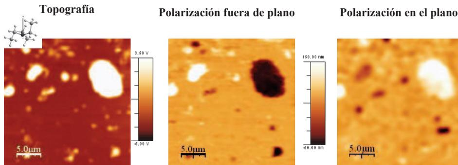
**Figura 2.** Imagen de trietanolamina (dentro de la imagen de topografía) depositada en una superficie conductora de oro. Se muestran los resultados de la topografía, las polarizaciones fuera del plano y en el plano. Las imágenes de las polarizaciones indican que al aplicar un voltaje DC sobre la superficie, existe un desplazamiento de la muestra, demostrándose así las propiedades piezoeléctricas del compuesto.
