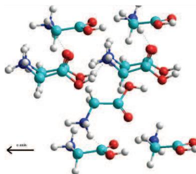
**Figura 6.** La gama glicina presenta polarización intrínseca en su estructura cristalina, es decir, las cargas positivas están orientadas en una dirección en todo el espacio y las negativas igualmente, haciendo posible generar propiedades electromecánicas.
