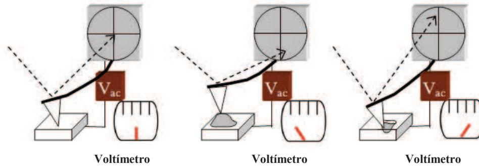
**Figura 1.** Aplicando un voltaje de corriente alterna, la punta del microscopio AFM puede producir una disminución o aumento del área topográfica medida, la cual a su vez es sensada por la punta del AFM produciendo una imagen de polarización piezoeléctrica independiente a la imagen de topografía. El voltaje (representado aquí por la aguja en el monitor del voltímetro) polariza (i.e., expande o contrae) a la superficie de la muestra dependiendo del signo de la corriente.
