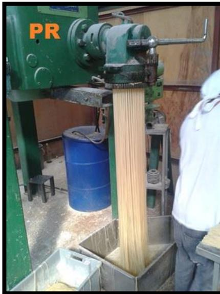
**Ilustración 27:** Prensa o Extrusor.
