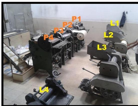
**Ilustración 24:** Codificación de Picadoras (P) y Laminadoras (L).
