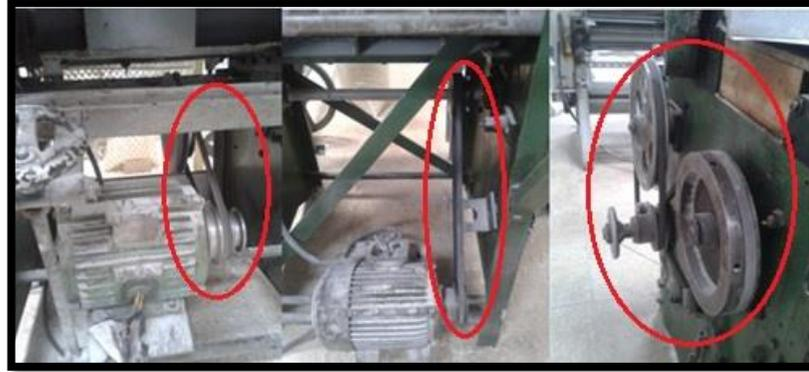
**Ilustración 58:** Riesgo en las Picadoras: Poleas de Motores.
