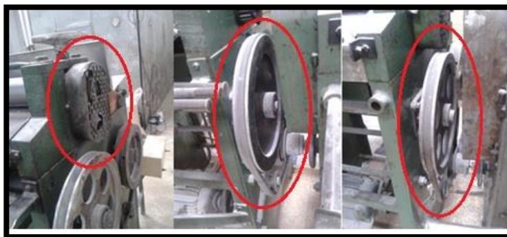
**Ilustración 57:** Riesgo en las Picadoras: Transmisión por bandas.
