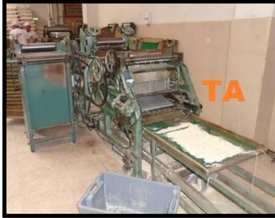
**Ilustración 33:** Tallarinera Automática. (TA)
