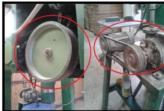
**Ilustración 60:** Riesgos en el Extrusor o Prensa.
