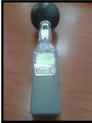
**Ilustración 102:** Medidor de estrés térmico.
