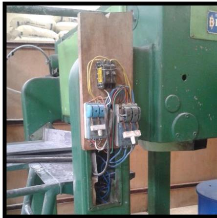
**Ilustración 77:** Encendido y Apagado. (Prensa)
