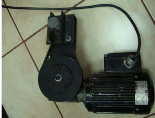
Figura 22: Motor reductor acoplado a un encoder incremental.
