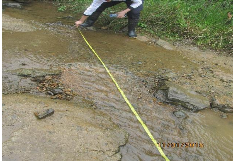
Figura 24. Medición de la distancia, el ancho y profundidad del río Chico, para calcular el caudal Fuente: Autores, 2015
