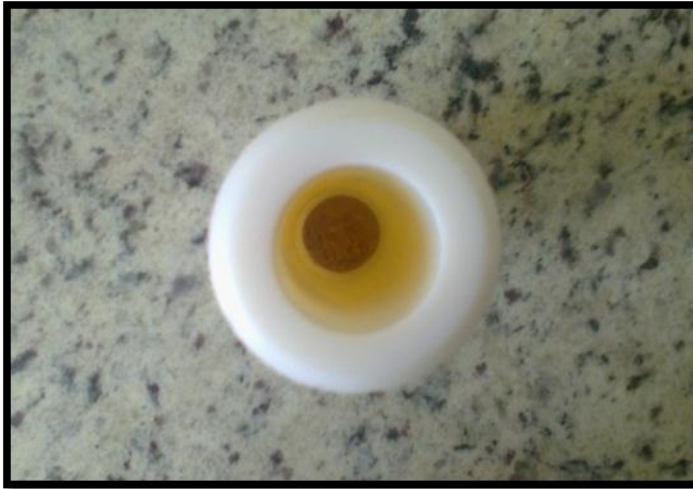
Figura 10: Reactor con una muestra de raquis de plátano antes del proceso de digestión ácida.
