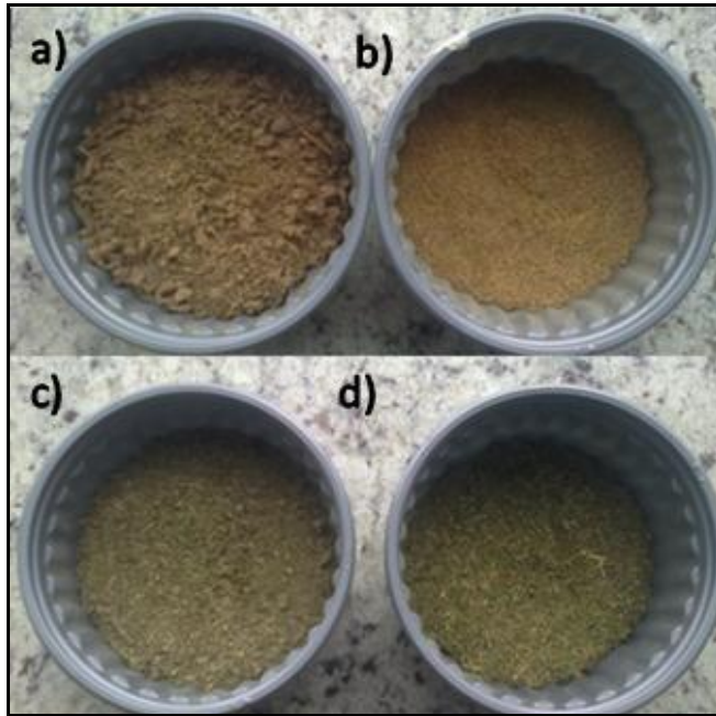
Figura 13: Diferencias en la coloración entre las matrices naturales y las matrices modificadas químicamente con ácido clorhídrico 2% (a) raquis de plátano modificado de color café claro (b) raquis de plátano natural con un color café oscuro (c) césped modificado con un color verde claro y (d) césped natural con un color verde oscuro.
