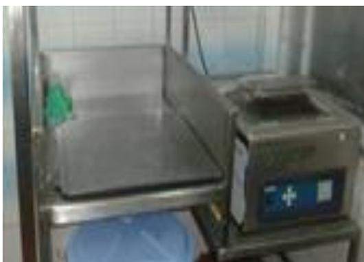
Ilustración 28. Gráfico 1.28 Empacadora al vacío Fuente: Autor
