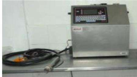
Ilustración 46. Gráfico 1.46 Codificadora Laser Fuente: Autor
