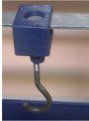
Figura 3.4 Sistema actual para aplicar la carga
