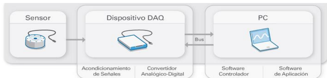
Figura1.23 Partes de una DAQ
