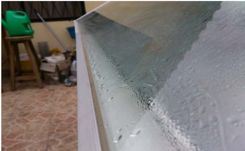
Figura 4.16. Destilador tipo caseta en funcionamiento
