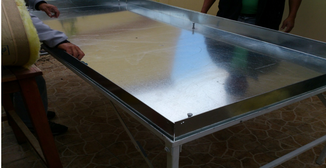
Figura 4.10. Ensamble del destilador parte inferior
