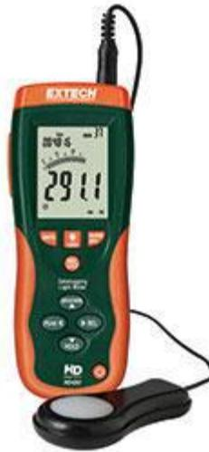
Ilustración 34. Luxómetro utilizado en las mediciones.
