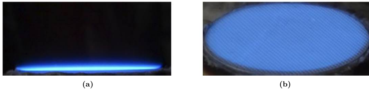
Figura 2. Registro visual de las llamas obtenidas en el quemador de combustión estabilizada en la superficie. a. registro lateral. b. registro frontal
