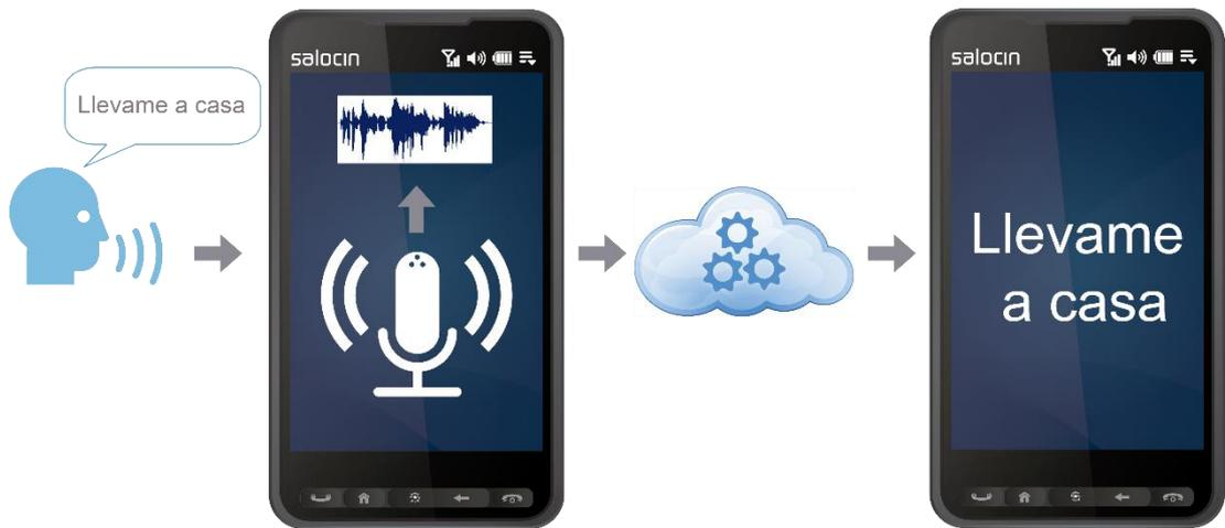
Figura 3. 4 Funcionamiento básico ASR.
