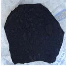
Para la elaboración de esta pólvora, el artesano utiliza una mezcla de carbón, azufre y salitre, en las siguientes proporciones: para media gruesa de cohetes, una libra de salitre, 5 onzas de carbón y 5 onzas de azufre; estos elementos mezclados en una piedra de moler, dan un polvo fino.
