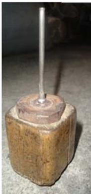
Esta herramienta se compone de una base de madera en la que se halla incrustada una pieza de hierro de 10 cm.
