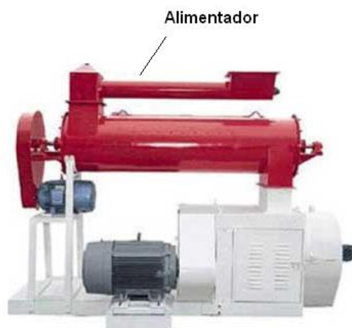
Figura 3.17 Alimentador y pre-acondicionador de la peletizadora (Fuente: http://www.Engormix.com )
