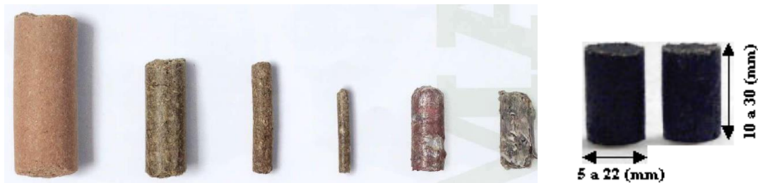
Figura 2.6 Tamaño del pellet. (Fuente: http://www.pelletheat.org )
