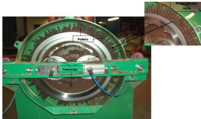
Figura 3.13 Proceso de Compactación del aserrín (peletizado)
