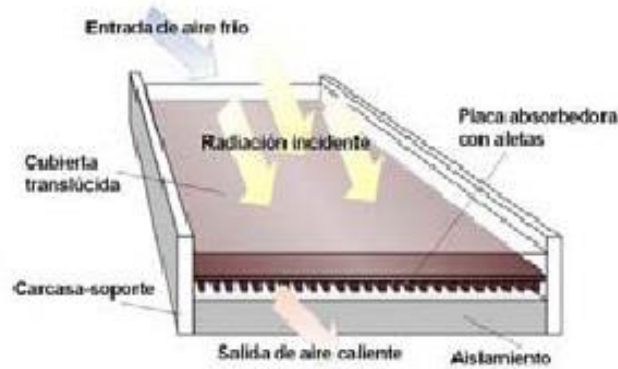
Figura 4.39 Esquema del panel solar (Fuente: Benítez, R.; Calderón, A. 1993. Secador solar para madera.)
