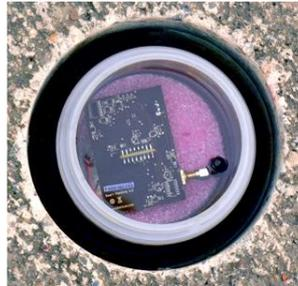
Figura 3.19: Sensor de parqueamiento dentro de su carcasa soterrado. [26]
