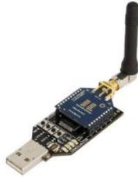
Figura 3.11: Gateway con un módulo 802.15.4 montado. [23]
