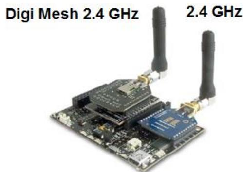
Figura 3.28: Wasmote router con módulos de DigiMesh 2.4 GHz y 2.4 GHz. [28]
