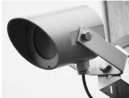
Figura 1.6: Sensor infrarrojo detector de presencia. [7]
