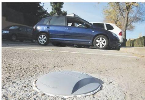
Figura 1.8: Sensor magnético ubicada en la calle Inteligente de Sant Cugat del vallès. [16]
