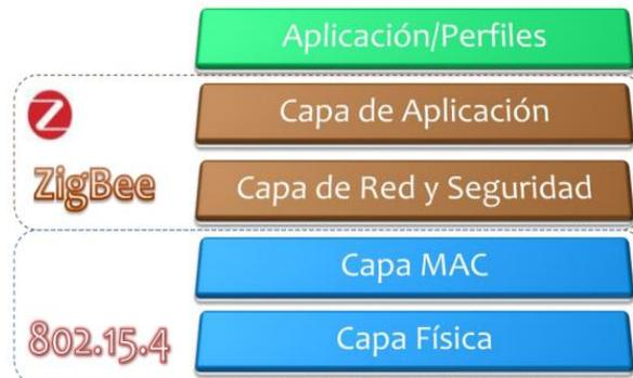
Figura 3.4: Pila de capa Zigbee. [4]
