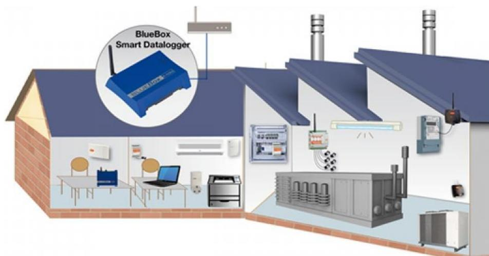
*Figura 3. 8: Esquema de conexión con Gateway BlueBox [25]*
