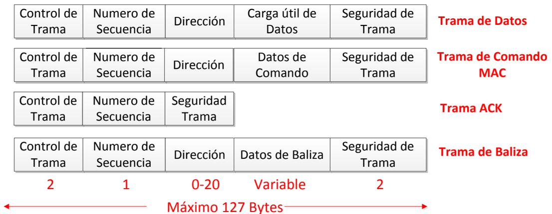
Figura 1. 10: Tipos de paquetes básicos de ZigBee [10]
