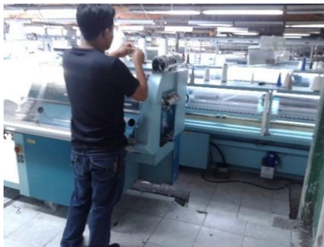
Figura 22. Ubicación de conos en la máquina tejedora Fotografía tomada el 13 de mayo del 2014
