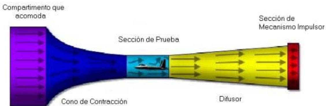
Figura 1. 10 Partes Túnel de Viento. Fuente [10]
