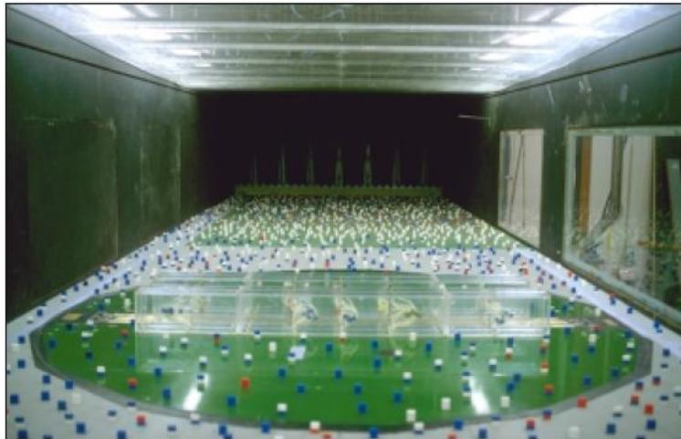
**Figura 1. 39 Viento modelo de túnel de un corredor urbano idealizado montado en el túnel de viento de capa límite atmosférica en la Universidad de Karlsruhe. Fuente [38]**
