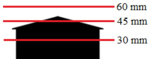
**Figura 4. 4 Alturas de análisis de velocidad perfil Triangular Centrado. Fuente [Autores]**
