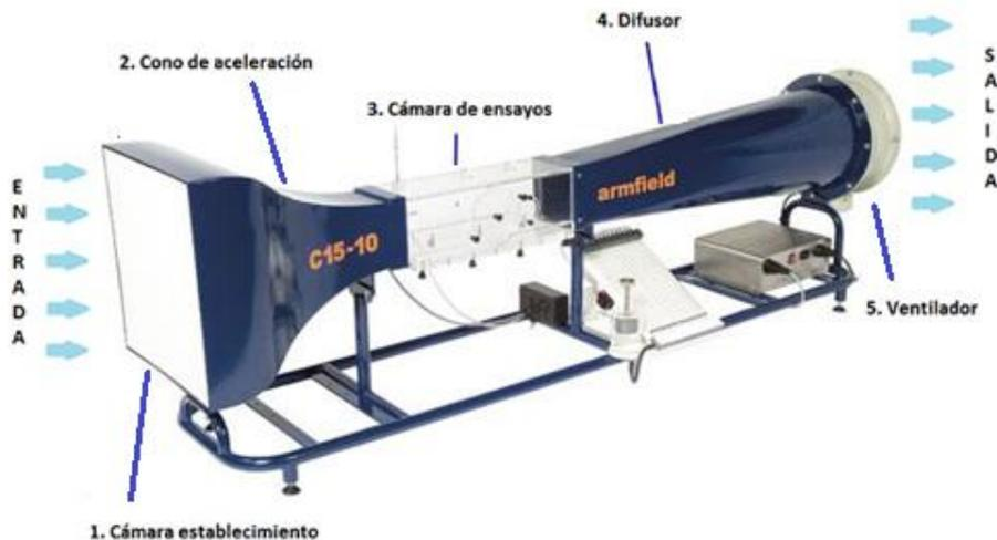
Figura 1. 33 Partes de Túnel de Viento Marca Armfield C15 (Laboratorio UPS). Fuente [35]
