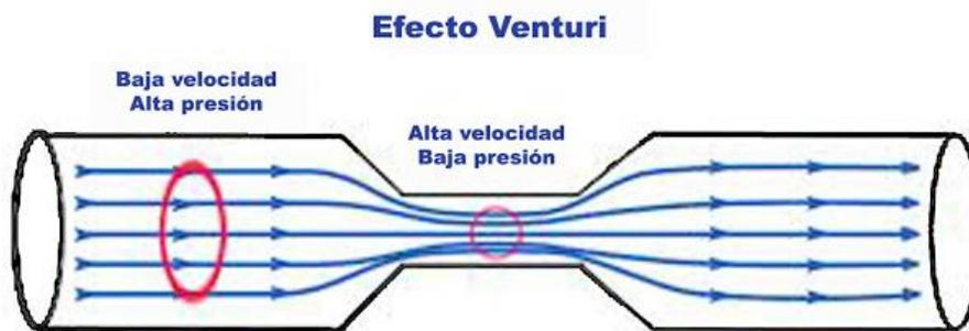
Figura 1. 29 Tubo de Venturi. Fuente [10]
