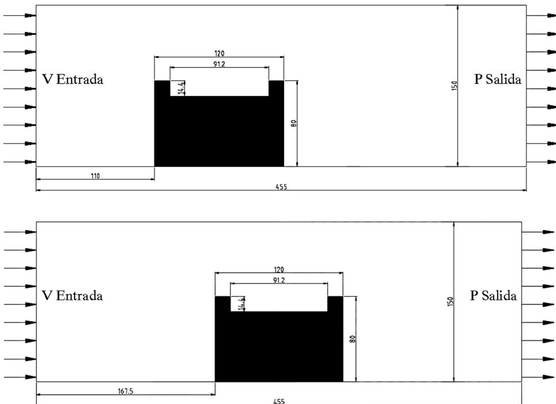
Figura 2. 1: Modelo físico de perfil H. Fuente [Autores]
