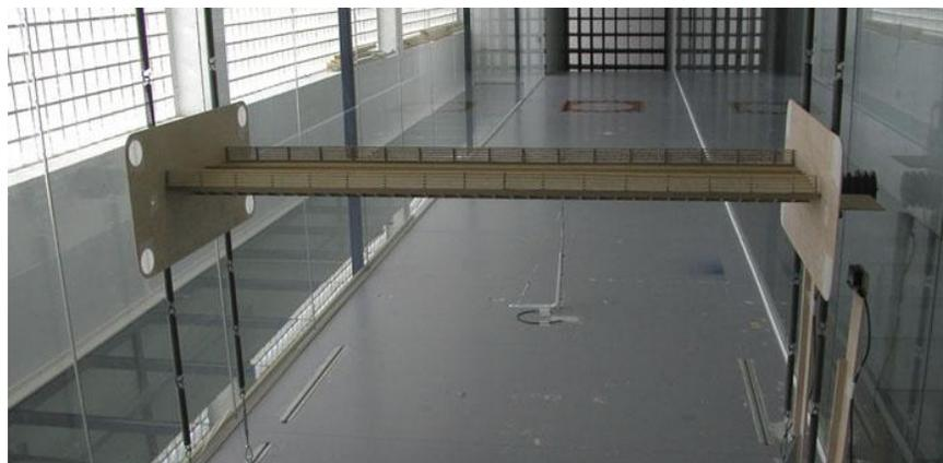
**Figura 1. 22 Puente en Túnel de viento. Fuente [26]**
