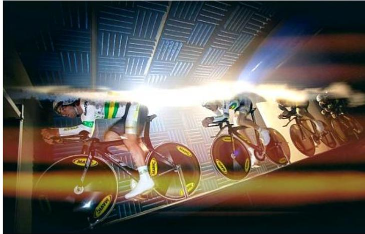
**Figura 1. 25 Pruebas de Ciclismo en Túnel de viento. Fuente [29]**
