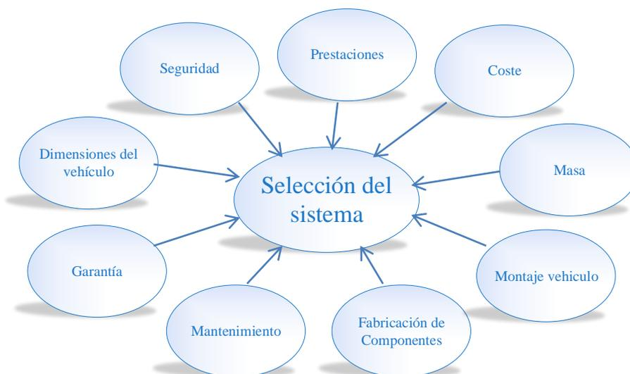
Figura 2. 1. Parámetros para la selección del sistema de suspensión.
