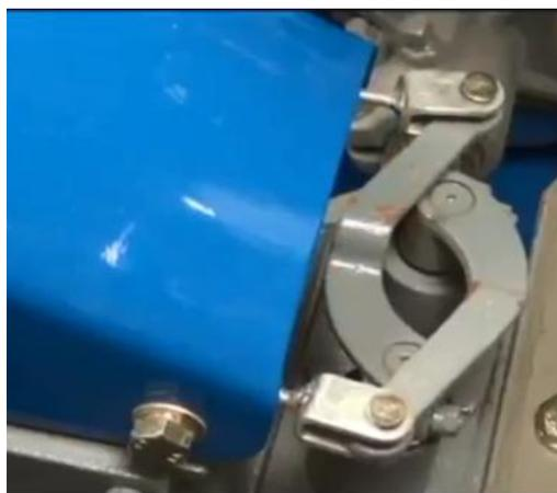
Figura 2. 5. Frenos para la dirección del motocultor
