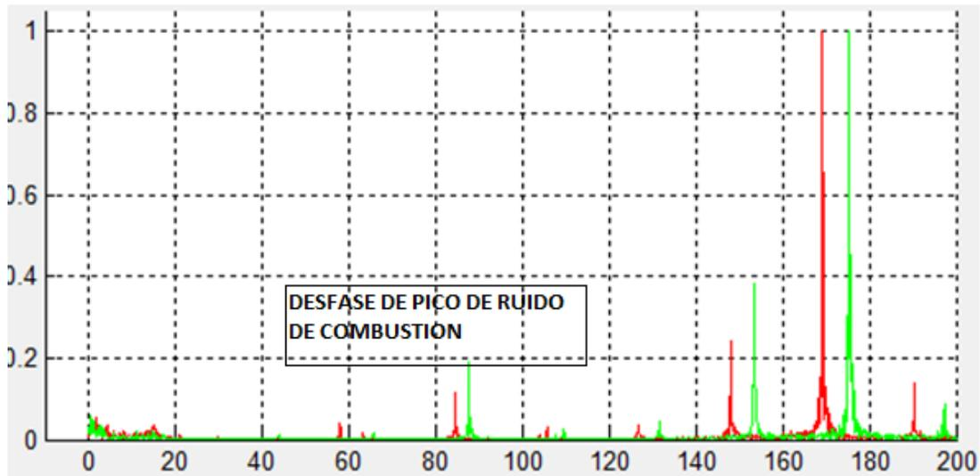
**Figura 4. 4** Espectros de ruido del efecto más crítico 2500 [rpm]. Fuente: [El autor]
