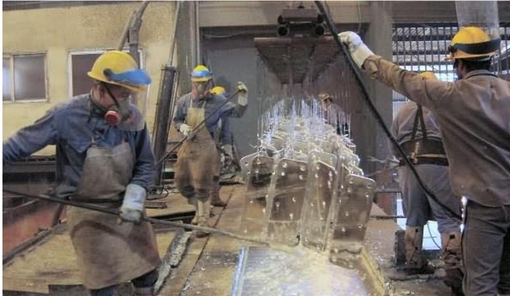
**FIGURA 15. FOTO TRABAJO EN EL ÁREA DE GALVANIZADO**
